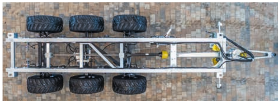
Vorbereitung als Wechselfahrgestell
