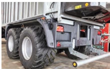
Blatníky, kryty kol a zadní zástěrka vyrobená ze speciálních plastových dílů zajišťujících čistý povrch a nižší riziko poranění člověka o stroj
