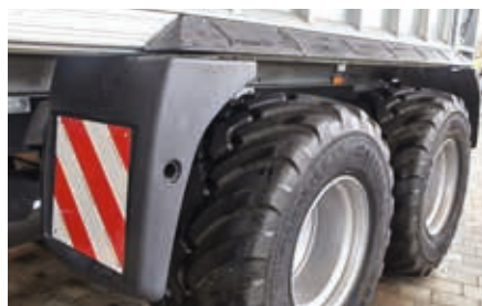
Blatníky, kryty kol a zadní zástěrka vyrobená ze speciálních plastových dílů zajišťujících čistý povrch a nižší riziko poranění člověka o stroj
