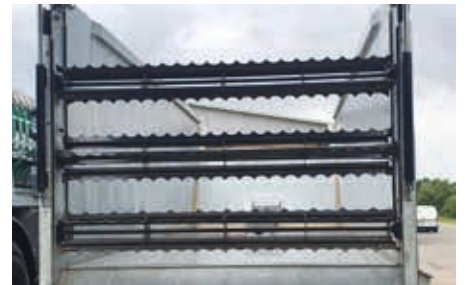
Dávkovací válec se 3 ležatými frézovacími válci
