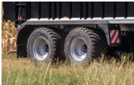
Varianty pneumatik do 800/45 R 22,5“ nebo volitelně 710/50 R 30,5“
