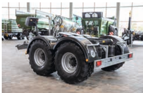
Tandemový vůz Dolly se zatížením čepu návěsu 17 t a celkovou hmotností 20 t
