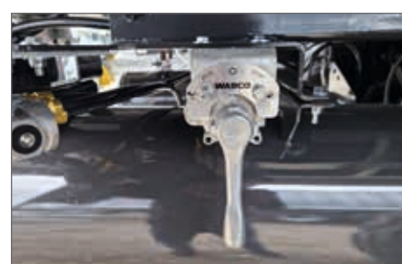
Zvedací a spouštěcí ventil u vzduchového odpružení
