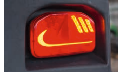
LED zadní svítidla „Dynamic“ z nárazuvzdorného materiálu s dynamickou funkcí směrových světel.
