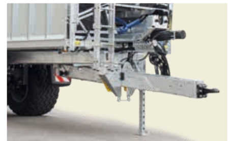
Průběžné hydraulicky odpružené tažné zařízení pro spodní zavěšení
