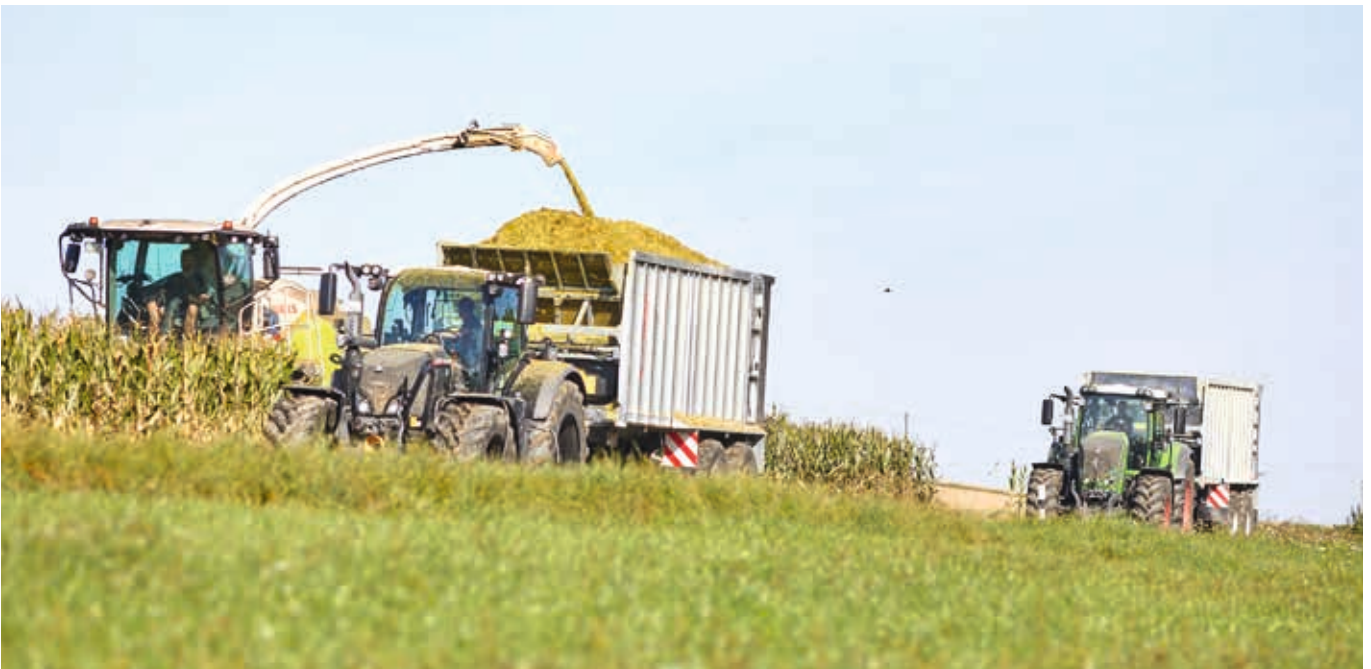
Nástavky 300 mm pro zvýšení objemu a čistoty korby zvenčí
