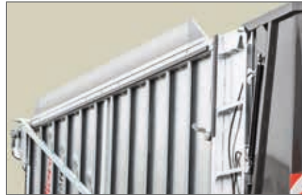
Nástavky 300 mm pro zvýšení objemu a čistoty korby zvenčí
