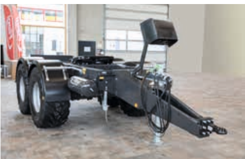
Tandemový vůz Dolly se zatížením čepu návěsu 17 t a celkovou hmotností 20 t
