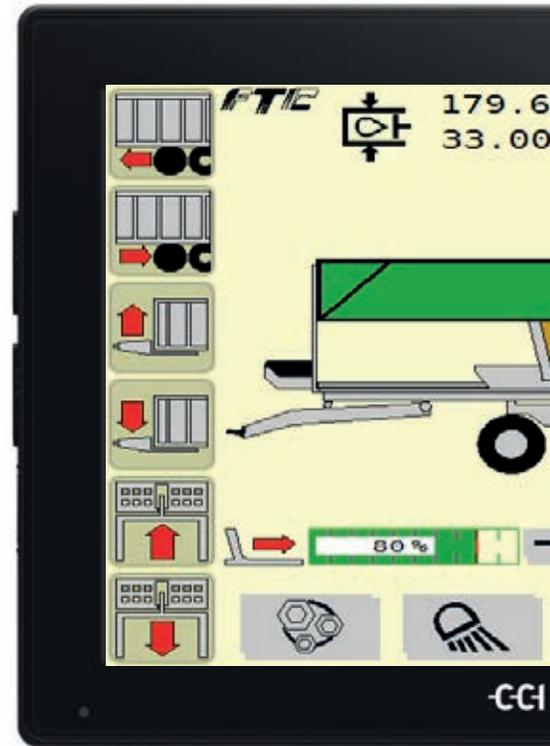
Die FTC nutzt einen fortschrittlichen Hydraulikblock mit Load Sensing-Technologie, wodurch weniger Schläuche und Anschlüsse benötigt werden. Dies führt zu einem schnelleren und sichereren Betrieb und minimiert die Gefahr von Bedienfehlern. Zudem bietet die FTC vielseitige Bedienungsmöglichkeiten: Sie kann entweder über eine benutzerfreundliche Isobus-Oberfläche oder ein Rocker-Bedienpult gesteuert werden, um den individuellen Bedürfnissen der Benutzer gerecht zu werden.
