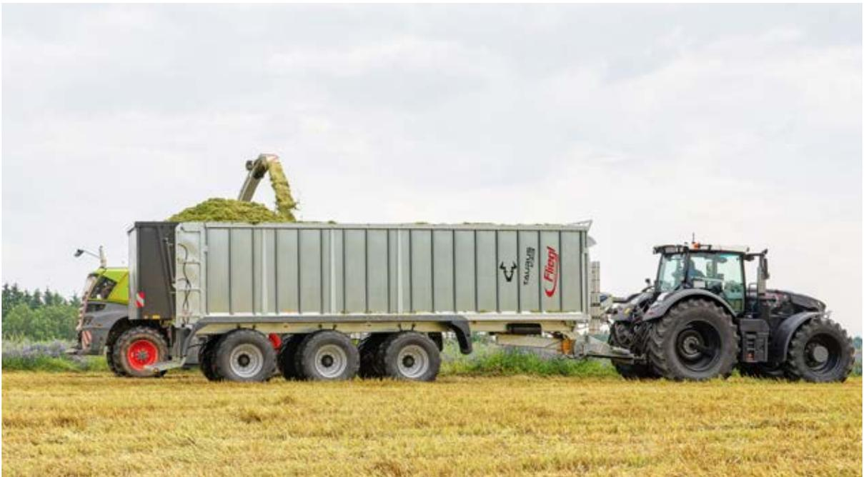
NEU: den ASW 3101 TAURUS und seinen etwas kleineren Tandem-Kollegen ASW 281 gibt es mit 710/50 R 30.5 Bereifung. Die großen Reifen sorgen für optimale Gewichtsverteilung. So wird der punktuelle Bodendruck enorm minimiert. Außerdem sorgen sie für ein angenehmes Fahrverhalten.
