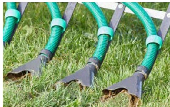
Die Schleppschuhdüsen TWIN mit einem Strichabstand von 125 mm lassen dicke Güllewürste der Vergangenheit angehören.
