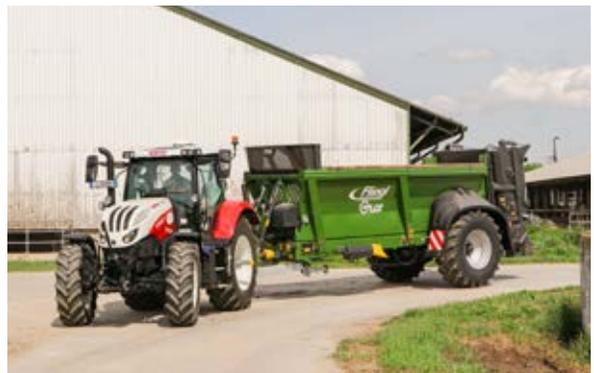
Der angefallene Mist der Kühe und Kälber wird mit einem Fliegl KDS 140 muck ausgebracht.
