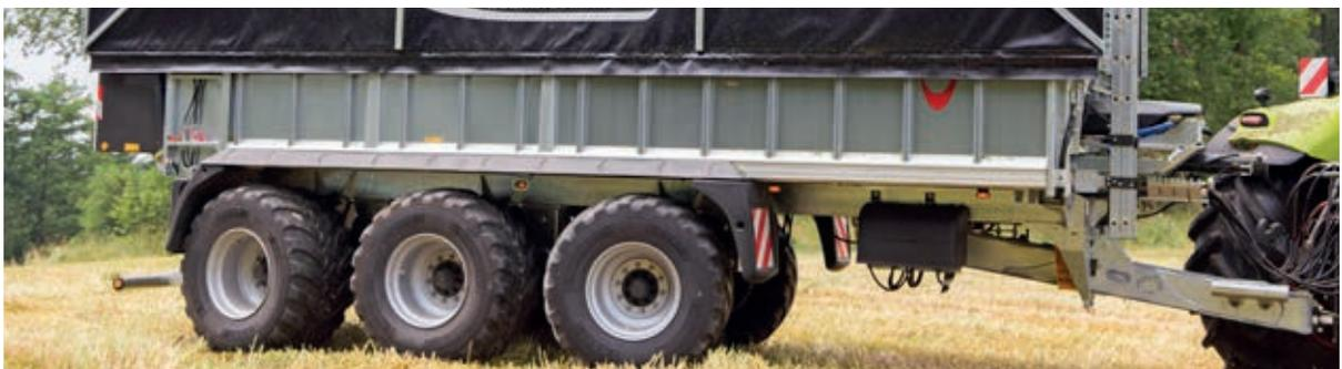
Das intelligente System »SteerX« errechnet sich anhand der Neigung und Fahrgeschwindigkeit des Schleppers den idealen Lenkeinschlag.
