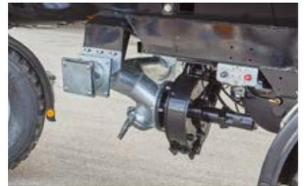
Turbobefüller 8" für beidseitiges Ansaugen
