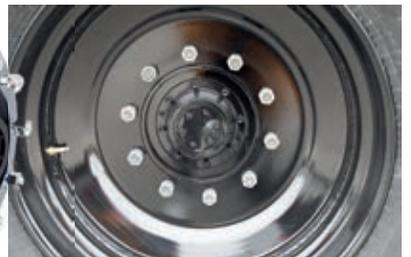
Der Radialkolbenmotor sorgt bei Bedarf für zusätzliche Antriebsleistung.
