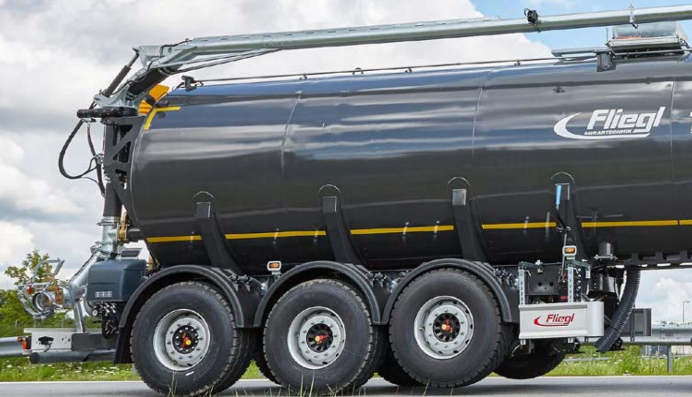
Das STF 30.000 Truck Line zeichnet sich durch sein Füllvolumen von rund 31.000 l sowie durch seine einzigartige Behälter- und Fahrwerkskonstruktion aus. Diese ermöglicht ein bemerkenswertes Leergewicht ab 5.400 kg in der Aluminium-Variante, ohne dabei auf eine hochwertige Serienausstattung zu verzichten.
