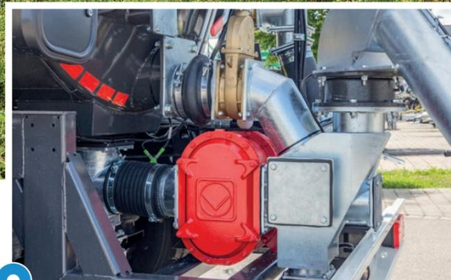
Leistungsstarke Drehkolbenpumpe von Vogelsang VX 186-260 Q mit Nachsaugfunktion zum Leersaugen des Gülleschlauches nach Vollmeldung
