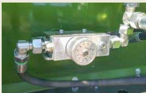
**Potentiomètre mécanique** avec vitesse d'avance réglable à l'avant sur la caisse d'épandeur
