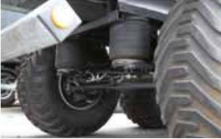
En option : suspension pneumatique avec basculement automatique
