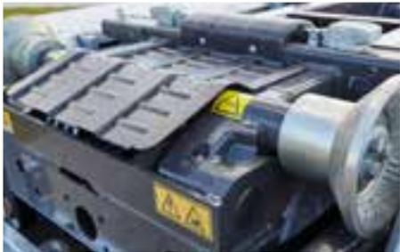
De grands rouleaux en acier coulé (ø 310 mm) à larges biais de centrage facilitent la mise en place du conteneur.
