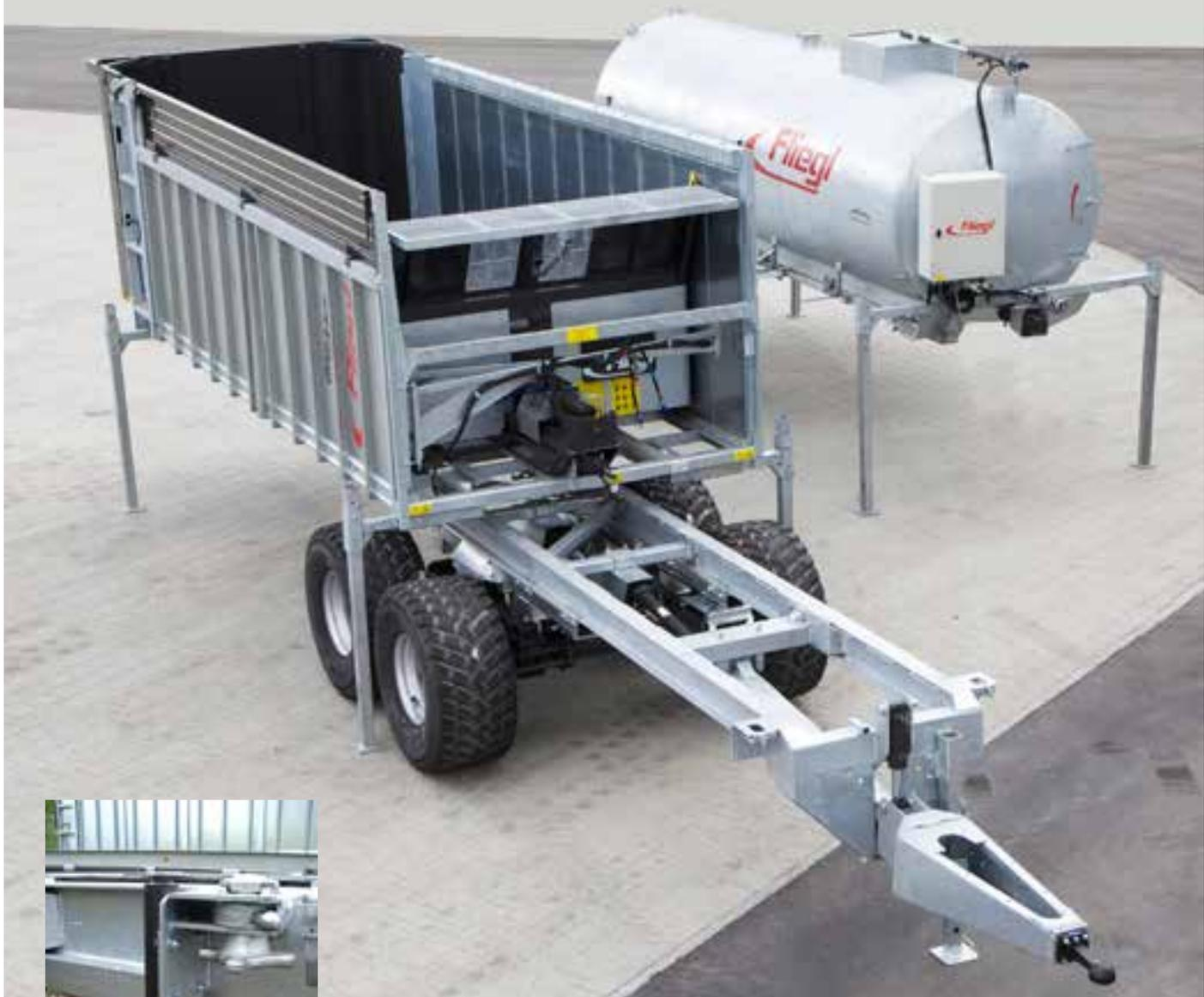
À partir de la remorque à fond poussant ASW 256 GIGANT, le châssis est équipé de série d'un système interchangeable. Ainsi, votre remorque à fond poussant Fliegl devient vraiment une remorque tout terrain.
