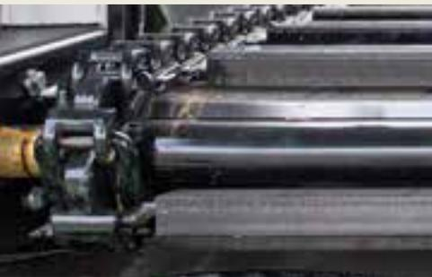
**Maillons forgés de Ø 20 mm** avec une charge de rupture allant jusqu'à 50 t ainsi que barres massives fermées en haut et écartées de 300 mm assurant le transport régulier et fiable des matériaux, y compris des matériaux extrêmement lourds.
