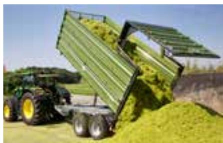
Benne d'ensilage avec paroi arrière hydraulique
