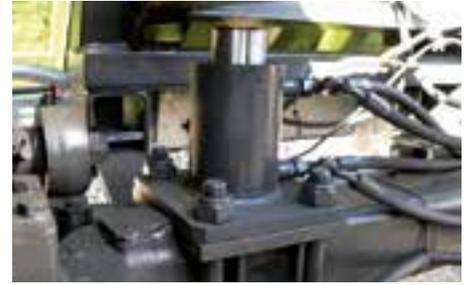
En option : support hydraulique sur l'essieu
