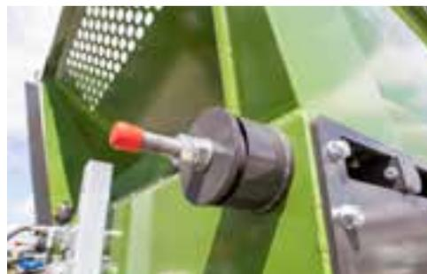
**Tension mécanique de la chaîne**
