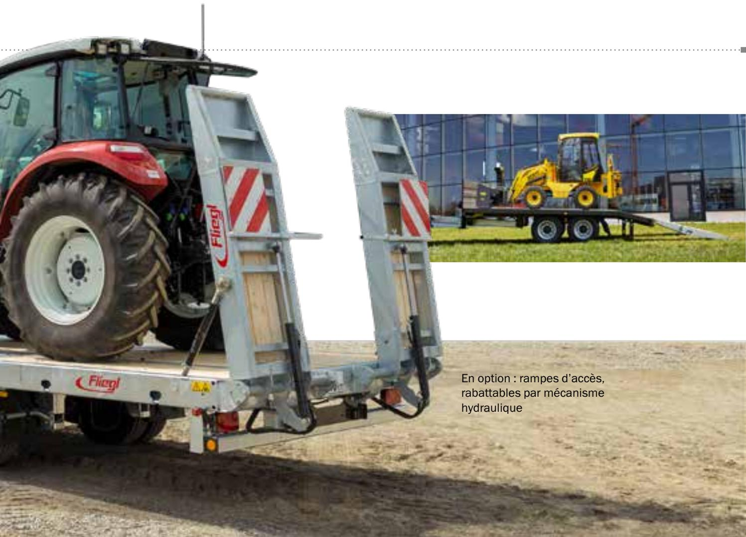
En option : rampes d'accès, rabattables par mécanisme hydraulique
