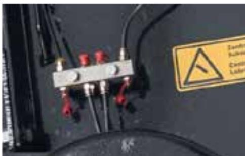
**Point de lubrification centralisé**
