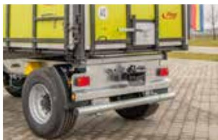
Support d'éclairage avec attelage de remorque automatique et trappe à grains
