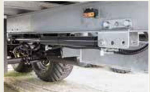
Décalage d'essieu hydraulique
