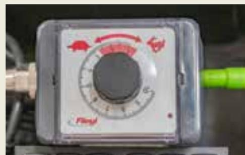
**Potentiomètre électrique** avec vitesse d'avance réglable sur le pupitre de commande
