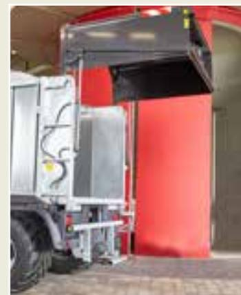
La protection anti-encastrement se rabat automatiquement vers le haut lors de l'ouverture de la large paroi arrière
