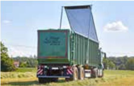
Déploiement par tension de ressort
