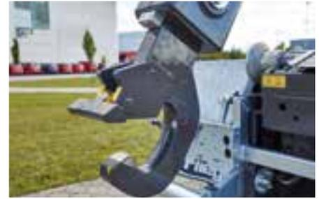
Geschmiedeter, einfach auswechselbarer Aufnahmehaken
