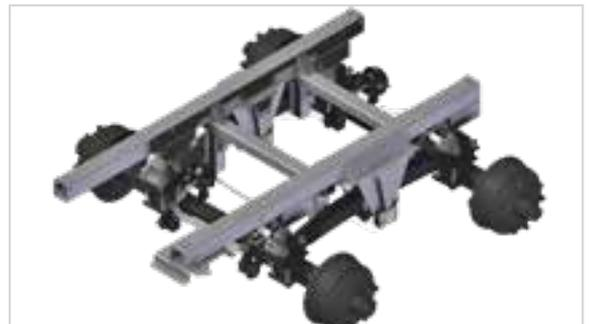
Titan-Tandemaggregat für besten Bodenausgleich, schmierlos und wartungsfrei.
