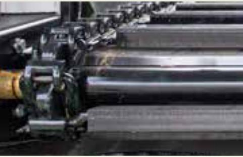
**Geschmiedete Kettenglieder Ø 20 mm** mit einer Bruchlast von 50t sowie massiv ausgelegte oben geschlossene Bandleisten sorgen mit einem Abstand von je 300 mm für einen gleichmäßigen und verlässlichen Materialtransport auch bei extrem schweren Materialien.
