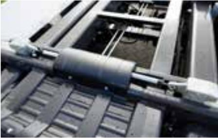
Umsteckbares Verriegelungssystem für Innen- und Aussenverriegelung
