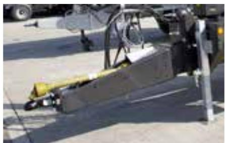
Drehbarer Zugholm für Oben- und Untenanhängung
