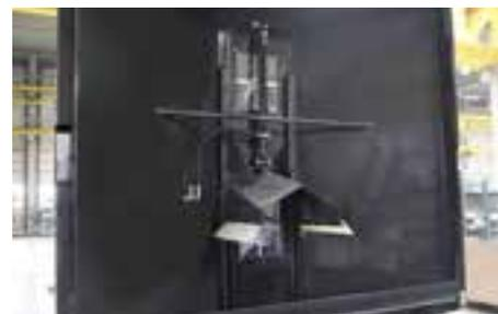
Hydr. Stauschieber ermöglicht im beladenem Zustand das komplette Entleeren der Überladeschnecke
