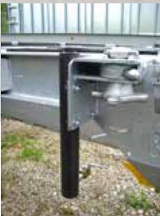
Zylinder für hydraulische Hebeeinrichtung
