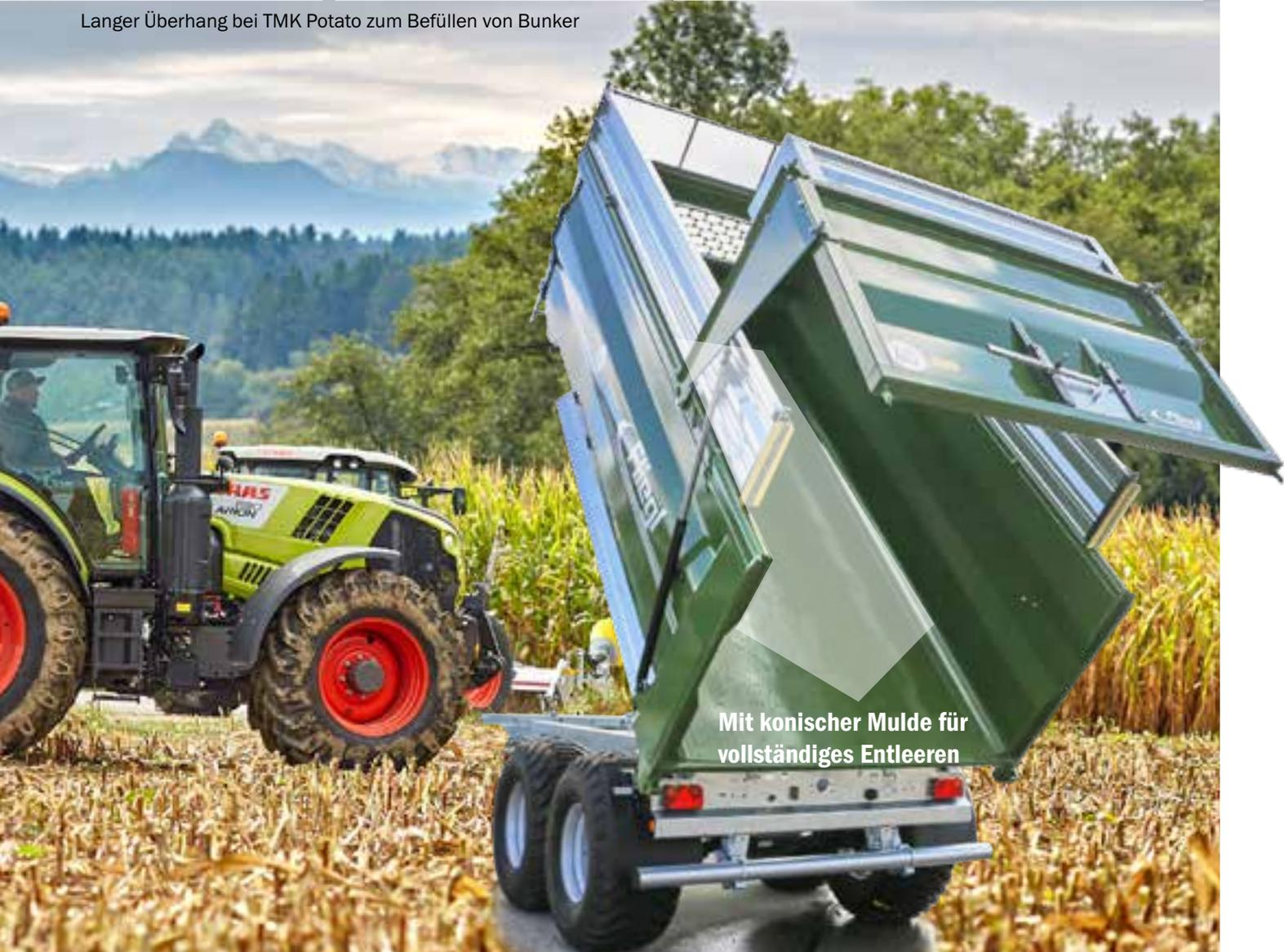
Mit konischer Mulde für vollständiges Entleeren
