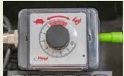
**Elektrisches Potentiometer** mit einstellbarer Vorschubgeschwindigkeit am Bedienpult
