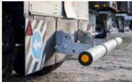
Optional: Unterfahrschutz mechanisch klappbar
