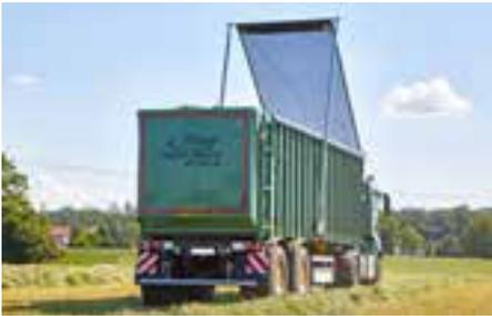
Aufziehen durch Federspannung
