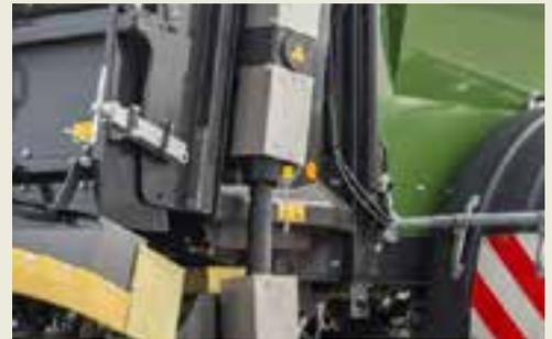
**Fräsrollenantrieb** über der Gelenkwelle
