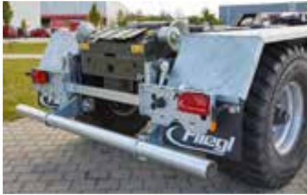
Optional: Ausziehbarer Beleuchtungsträger
