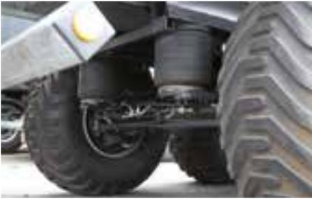
Optional: Luftfederung mit automatischer Kippabsenkung
