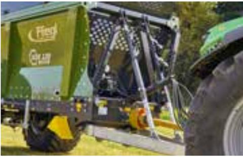
**Hydraulisch gefederte Zugdeichsel für Tiefbettstreuer / Untenanhängung.**
