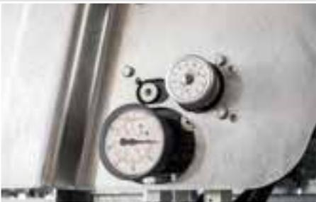
Mechanisches Potentiometer mit einstellbarer Vorschubgeschwindigkeit am Streuwerk
