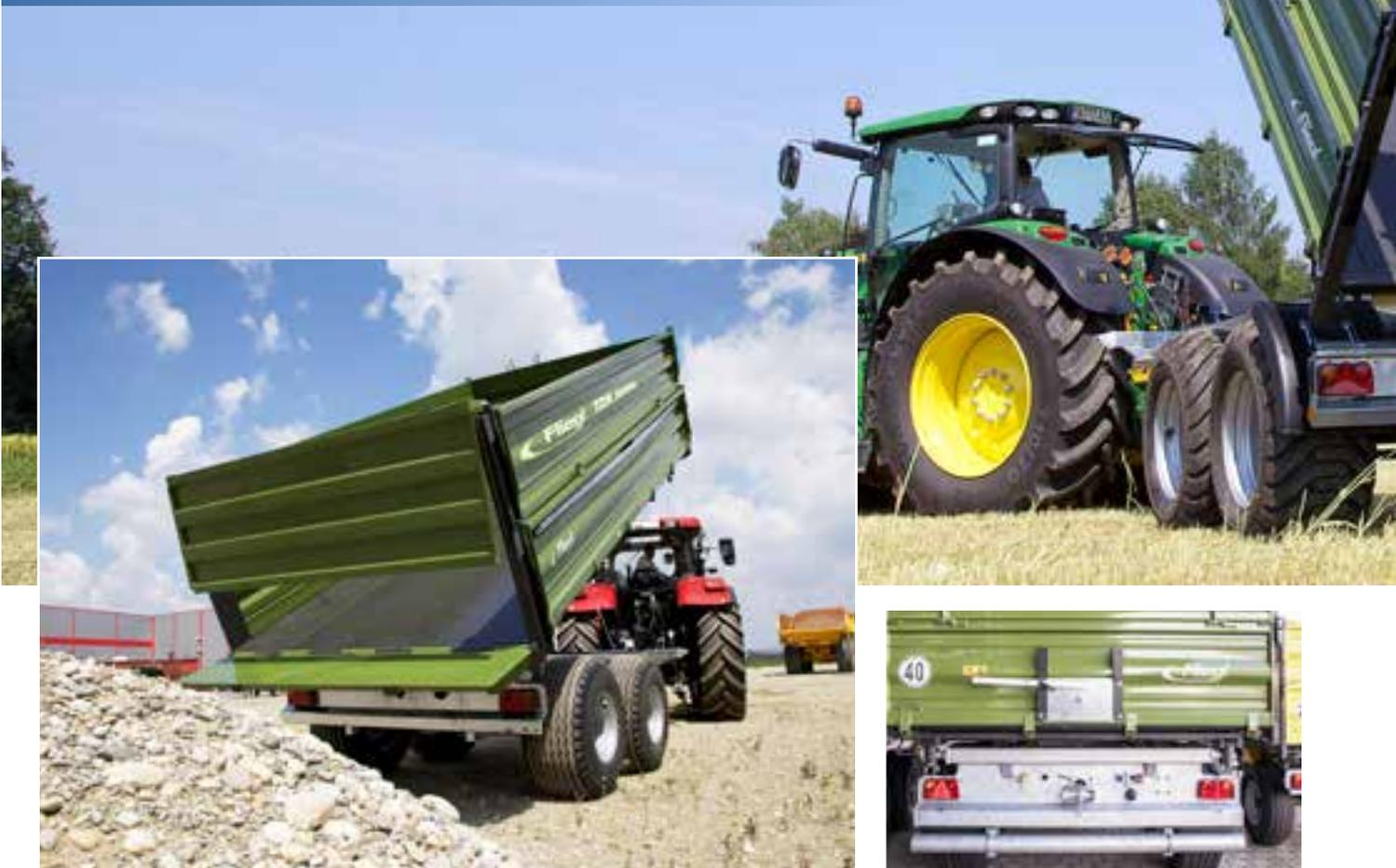
TDK 160 mit hydr. Schotterklappe 500 mm | Brücke aus verschleißfestem Stahl 450 HB, Eckrungen verschweißt. Brücke: 5000 x 2320 x 2220 mm
