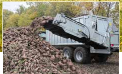
RUBY átrakószalag cukorrépa számára, átrakóteljesítmény kb. 15 m 3 /perc
