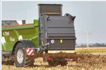
A varioSPLASH tányéros szórószerkezettel akár 32 m-es munkaszélesség is lehetséges.
