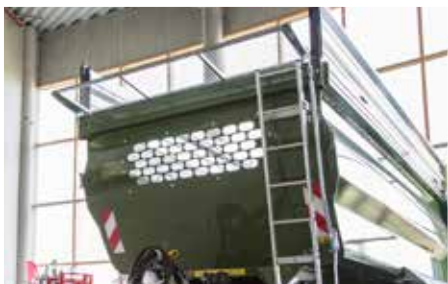
Mechanikusan behajtható védőrács
