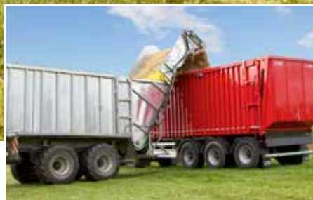
Fű vagy faapríték áttöltése »MobilFast« áttöltőszalaggal
