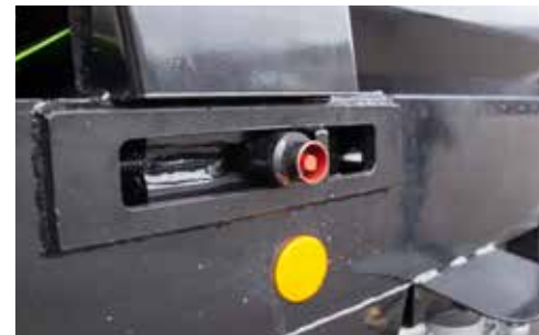
Kényelmesen hozzáférhető, kenhető, kétoldali láncfeszítő
