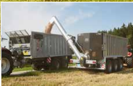
Búza áttöltése 400-as átrakócsiga segítségével (kb. 7,5 t/perc)
