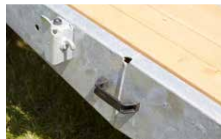
TPA 120 feljárórampa falecekből készült, festett plató 3,5mm-es acéllemezből
