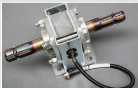
„VARIO SENS“ automata szórásvezérlés nyomatékérzékelője
