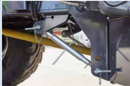
A vízszintes hengerek meghajtórendszere. Túlterhelés elleni védelem a nyomatékhatárolós (racsnis) kardántengellyel.
