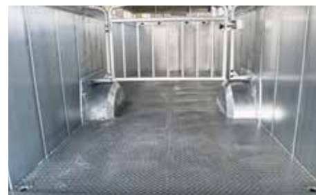
A bordázott acéllemez stabil állást biztosít az állatoknak.
