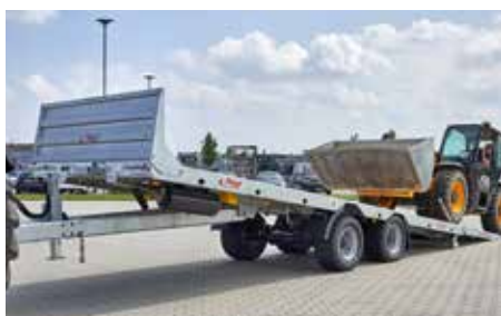
Hidraulikusan dönthető vonórúd TPA 200-tól
