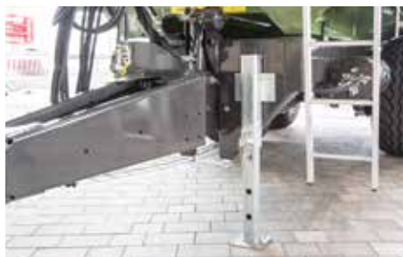
Hidraulikus rugózású vonórúd, mechanikus támasztólábbal TMK 256-tól
