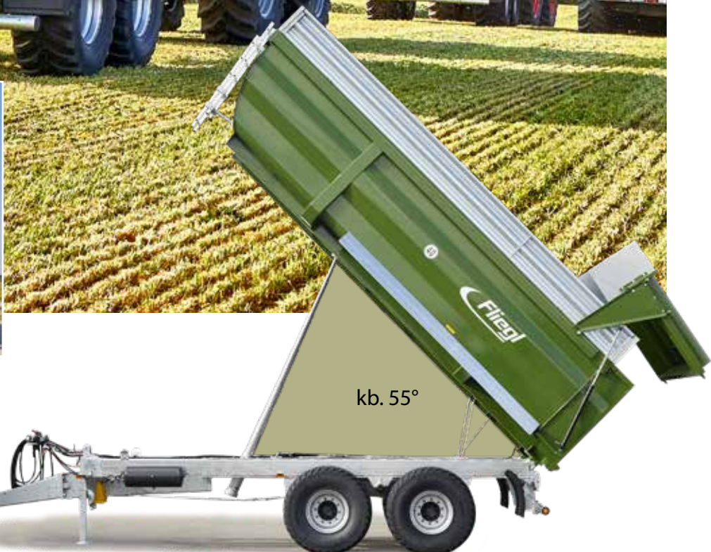
Tandem TMK 269 Profi 6,90 méteres teknőhosszával és 55°-os billentéssel
