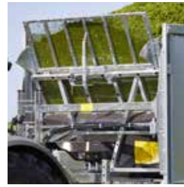
Jól átlátszó, ütészálló műanyagból készült „Insight” letolóhomlokfal
