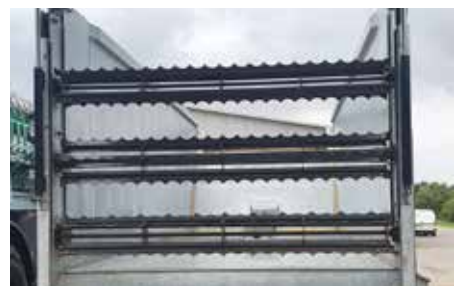
Szórószerkezet 3 db fekvő lazítóhengerrel
