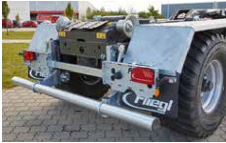
Opcionális: kihúzható lámpatartók
