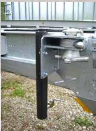
Munkahenger a hidraulikus emelőberendezéshez
