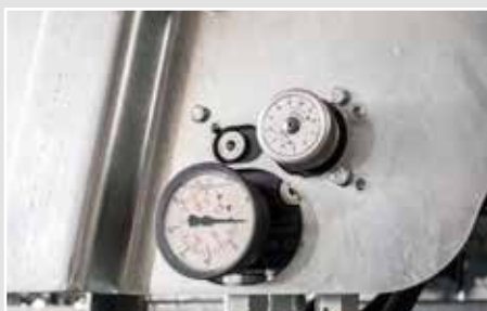
Mechanikus potenciométer, szórószerkezeten beállítható letolási sebességgel.
