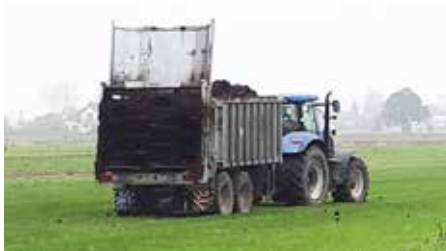
»Profí V2n« szórószerkezet Legalább 1500 mm oldalfal-magasságú letolókocsikhoz
