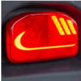
„Dynamic” LED-es hátsó lámpa, mozgófényes irányjelző-funkcióval, ütészálló anyagból
