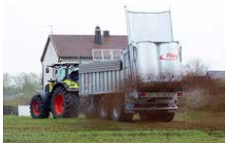
»Profí V2« szórószerkezet zárt, széles szóróhátfallal
