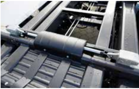
Áthelyezhető zárszerkezet a külső és belső rögzítéshez
