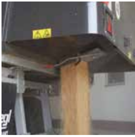
Nagy térfogatú hidraulikus hátsó ajtó gabonakieresztő ablakkal
