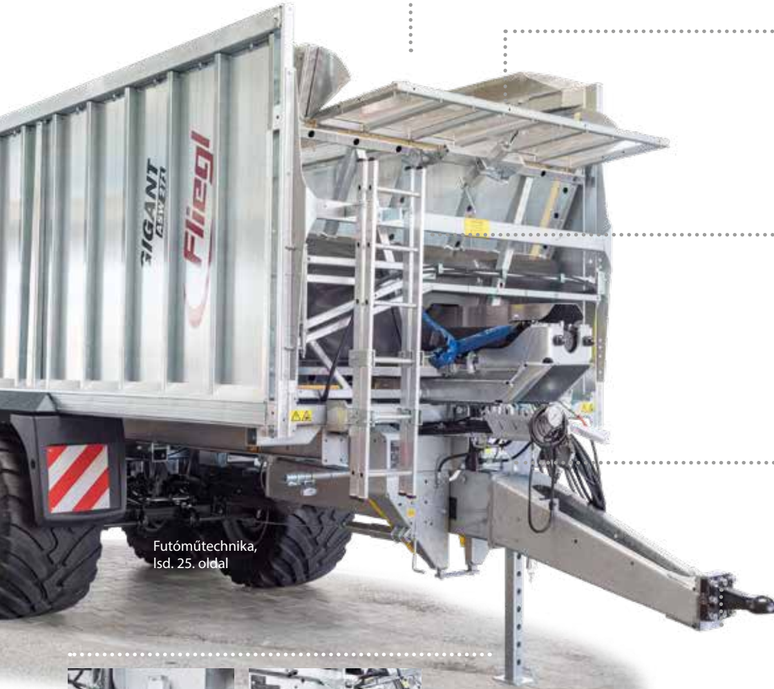
Nagy térfogatú hidraulikus hátsó ajtó gabonakieresztő ablakkal
