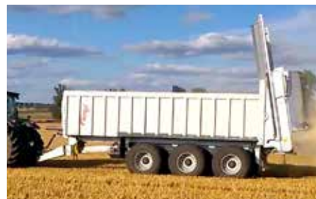
Szórószerkezet zárt szélesszóró hátfallal
