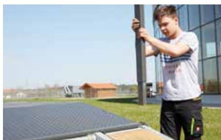
Kivehető rakoncák az egyszerű felhajtásért
