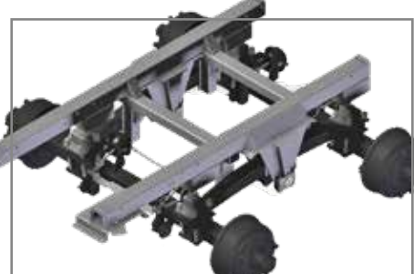
»Titan« tandem futómű a legjobb talajkiegyenlítésért
