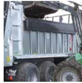
Mechanikusan lehajtható oldalfal
