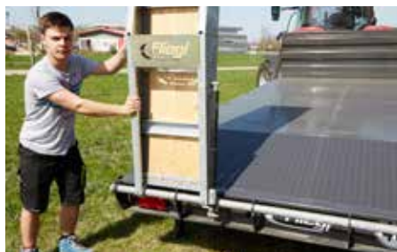
Praktikus: Eltolható feljárórész a megfelelő nyomtáv kiválasztásának érdekében
