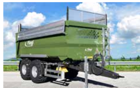
Lehajtható, horganyzott magasító
