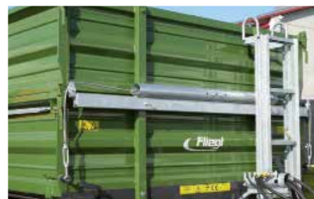
Opcionális: erős kivitelű oldalfeszítő rugó
