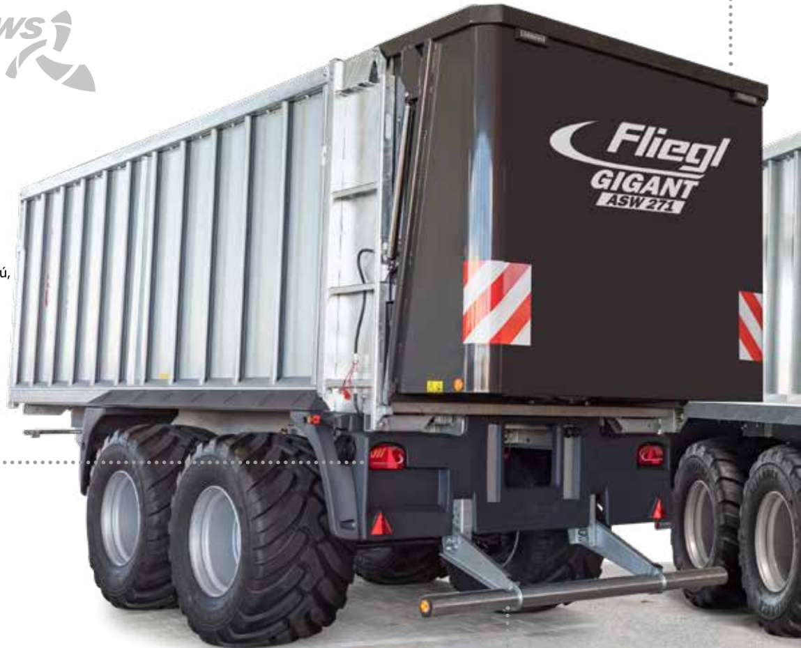
„Dynamic” LED-es hátsó lámpa, mozgófényes irányjelző-funkcióval, ütészálló anyagból
