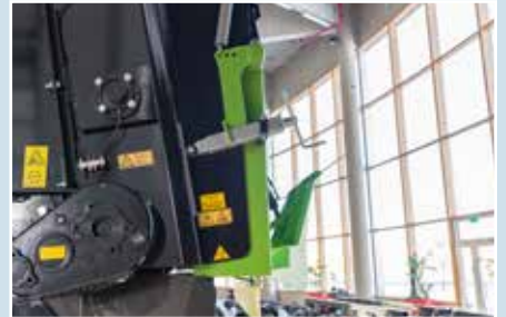
A vízszintes hengerek meghajtórendszere. Túlterhelés elleni védelem a nyomatékhatárolós (racsnis) kardántengellyel.
