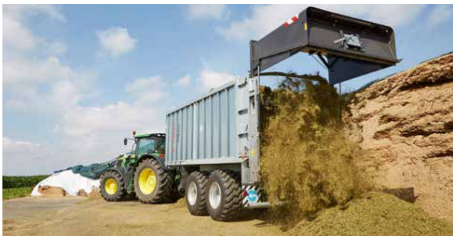
Szórószerkezet 3 db fekvő lazítóhengerrel
