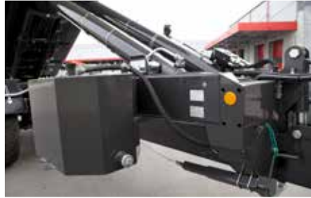
60 literes (opcionálisan 90 l) fedélzeti hidraulika, kardanmeghajtás hidraulikaszivattyúval és olajtartállyal
