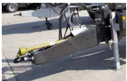
Megfordítható vonórúd a felső- és alsókapcsoláshoz
