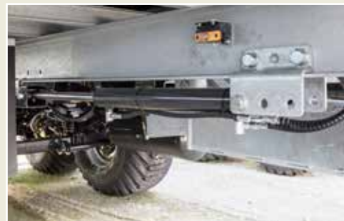
Hidraulikus, fokozatmentes tengelyeltolás
