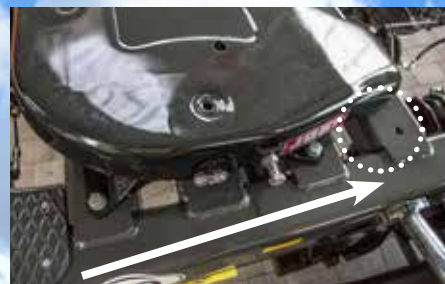
Mechanikus nyeregszerkezet-eltolás egytengelyes és tandem Dollynál
