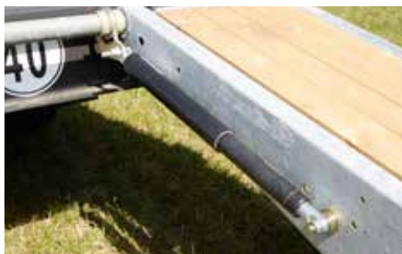
Feljárórampa alakjavitelben rugós emelő- vel, opcionálisan hidraulikus emelővel is
