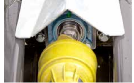
60 literes (opcionálisan 90 l) fedélzeti hidraulika, kardanmeghajtás hidraulikaszivattyúval és olajtartállyal
