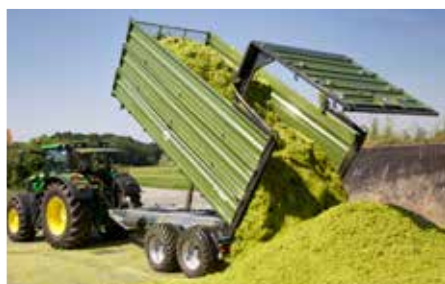
Silószállításához billentős pótkocsi hidraulikus hátfallal
