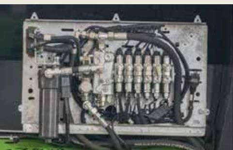
**Électrovanne** avec pupitre de commande pour une utilisation plus confortable
