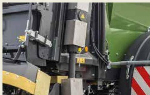
**Entraînement des rouleaux fraiseurs par l'arbre de transmission**
