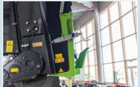
L'épandeur à disque **varioSPLASH** possède deux grands disques d'épandage de  $\varnothing$  1100 mm, chacun doté de 6 panneaux d'éjection réglables transversalement par rapport à l'angle d'éjection. Ils sont équipés de plaques remplaçables en HB 400 et leur sensibilité peut être modifiée au moyen de chevilles de sécurité. Sur les modèles tandem et tridem, l'angle de la table d'épandage peut être réglé mécaniquement ou, en option, hydrauliquement.
