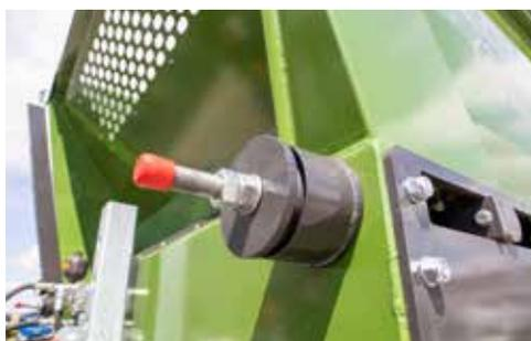
**Tension mécanique de la chaîne**
