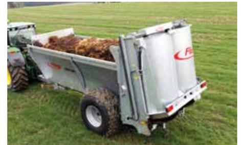
La technologie de poussée éprouvée de Fliegl assure l'alimentation en matériau régulière de l'épandeur. Après l'épandage, l'espace de stockage est bien vidé et le fond reste propre, à l'inverse de l'épandage avec un fond racleur traditionnel.
