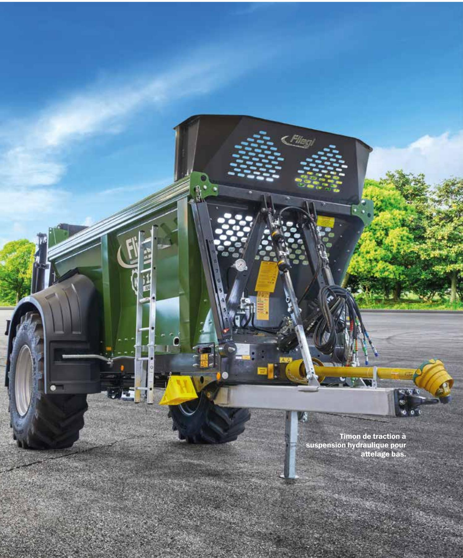
Timon de traction à suspension hydraulique pour attelage bas.
