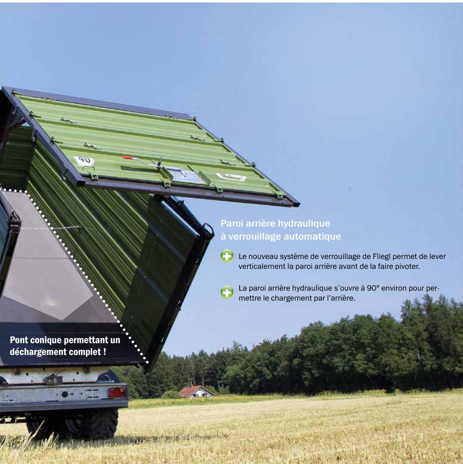
**Pont conique permettant un déchargement complet !**
