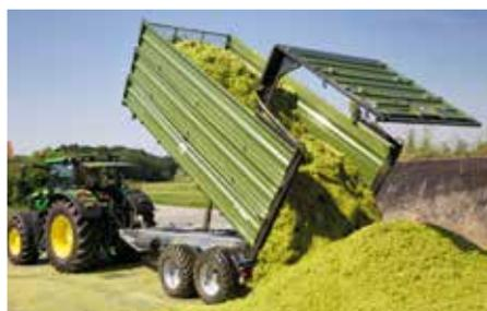
Benne d'ensilage avec paroi arrière hydraulique
