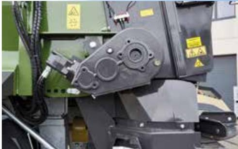
La transmission latérale lourde assure l'alimentation uniforme du matériau sur un arbre de 60 mm
