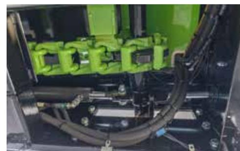
**Tension hydraulique de la chaîne**
