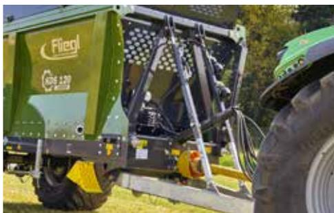
**Timon de traction à suspension hydraulique pour épandeur Tiefbett/attelage bas.**
