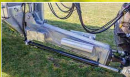
En option : direction forcée hydraulique
