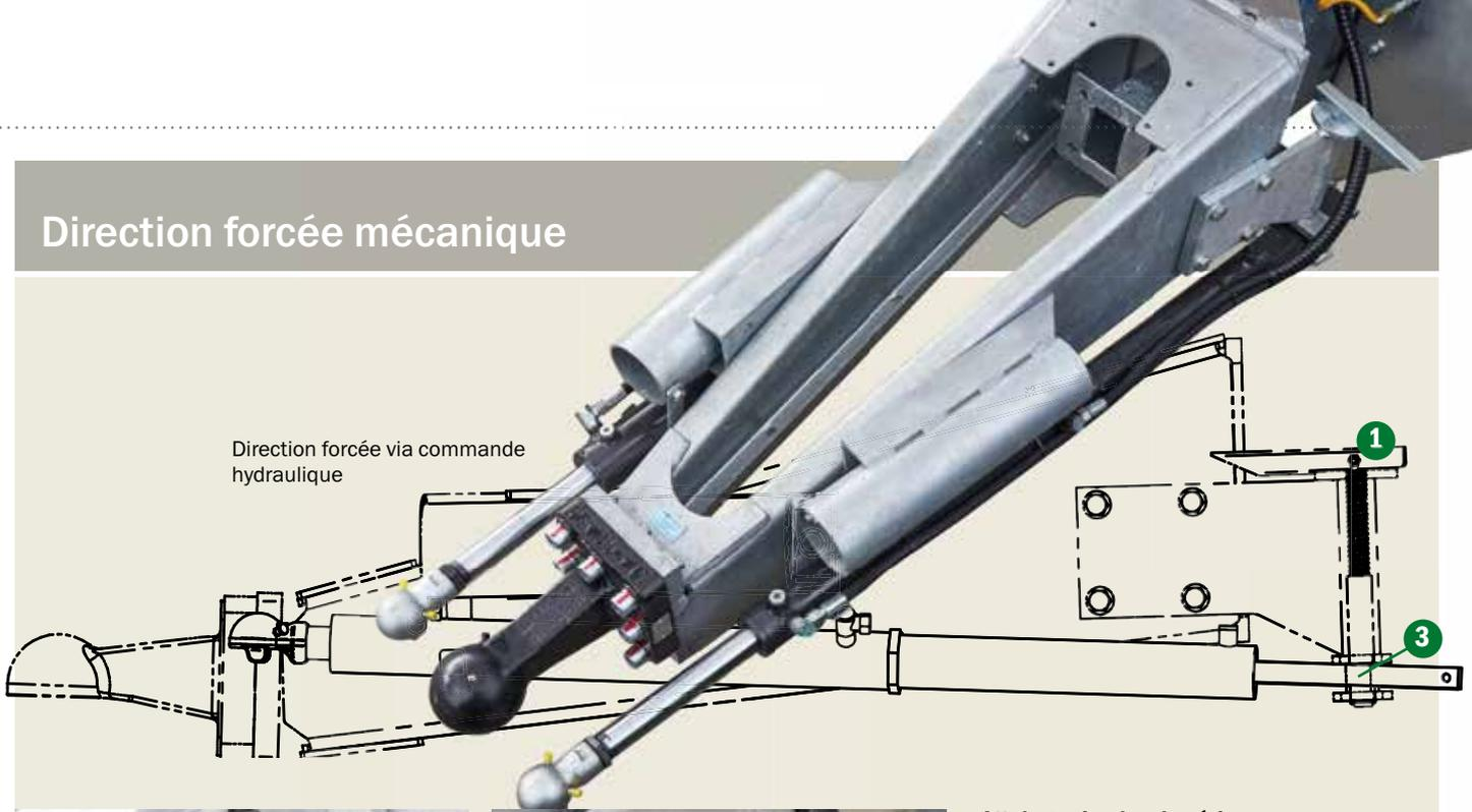
Direction forcée via commande hydraulique
