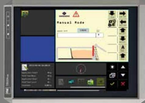
L'ISOBUS Multi-Control est une commande de machine multiple. Elle permet l'utilisation simultanée du VARIO SENS de FLIEGL et par ex. du TRAILER CONTROL de FLIEGL. La commande multiple permet ainsi de faciliter le travail de l'utilisateur et d'augmenter également l'efficacité de l'application.
