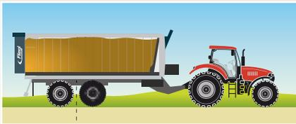
Adaptation optimale de la charge d'appui par décalage d'essieu mécanique (de série) ou adaptation hydraulique continue (option) de la charge d'appui même en cas de montage d'accessoires (par ex. mécanisme d'épandage)
