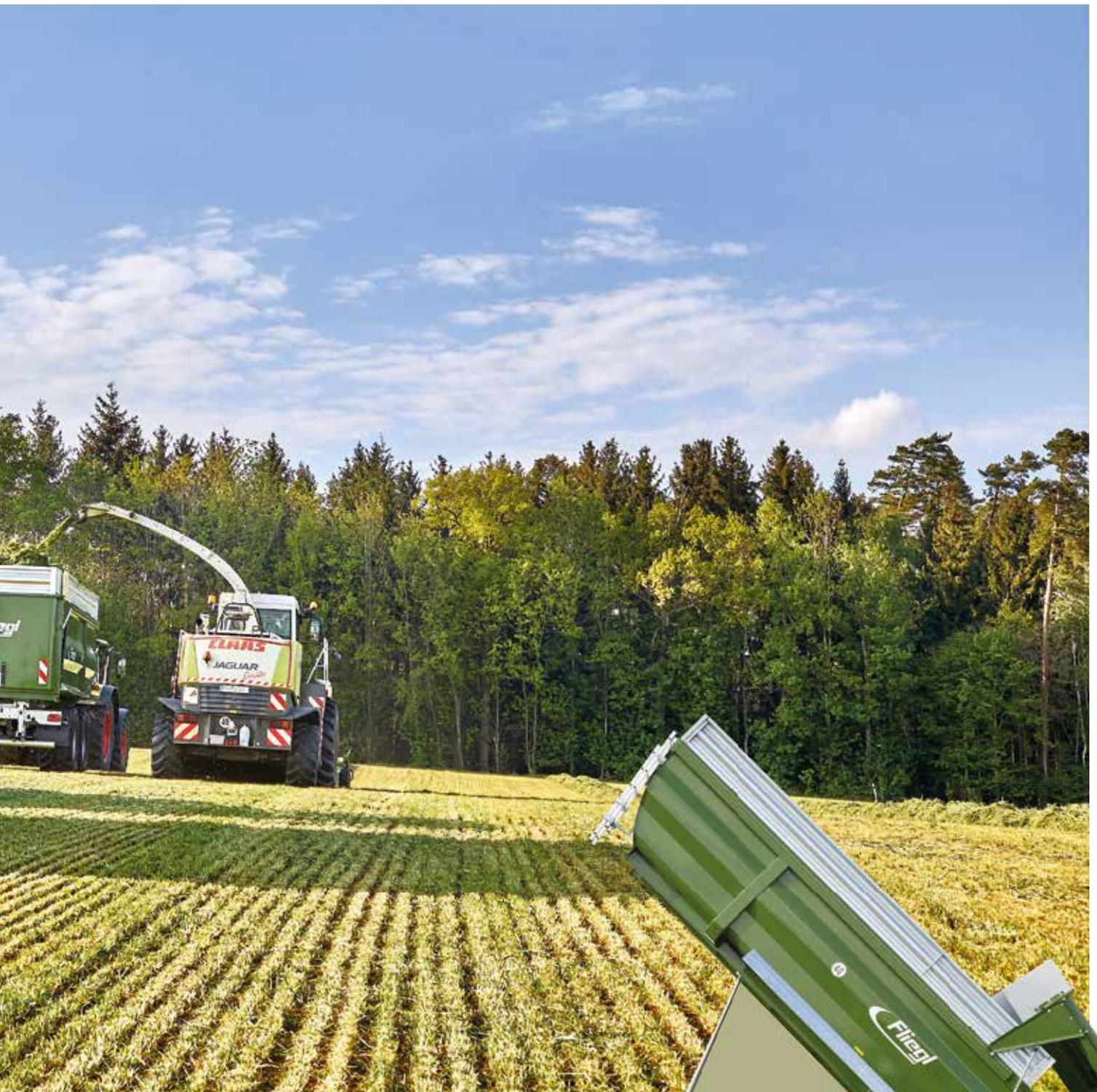
Benne tandem TMK 273 Profi d'une longueur de 6,80 m avec un angle de basculement d'env. 55°
