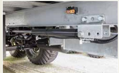
Décalage d'essieu hydraulique
