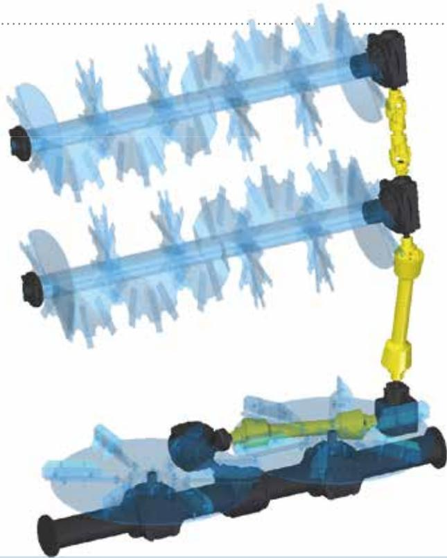
Chaîne cinématique des hérissons horizontaux. Limiteur de charge par embrayage à came dans l'arbre de transmission au tracteur.
