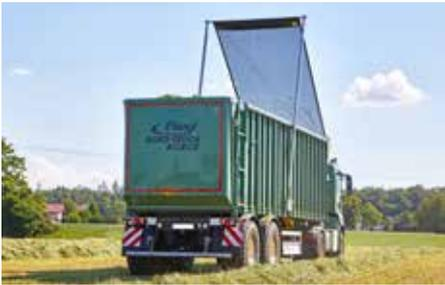
Déploiement par tension de ressort
