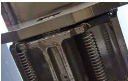
Verrouillage automatique du crochet lors du basculement
