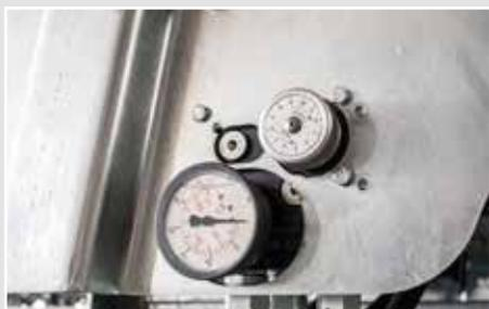
Potentiomètre mécanique avec vitesse d'avance réglable sur l'épandeur
