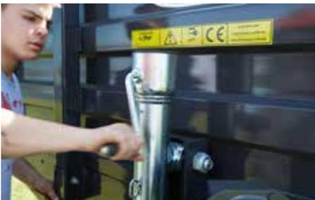
Barre de traction avec réglage par axe
