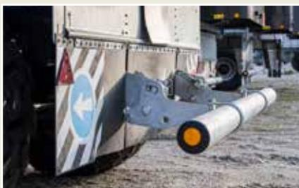
En option : protection anti-encastrement arrière rabattable mécaniquement
