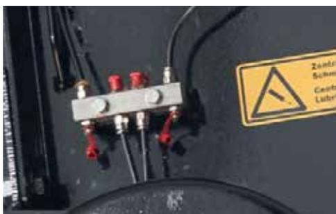
**Point de lubrification centralisé**
