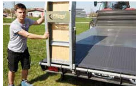
Pratique : décalage possible des segments pour adapter la largeur de voie des rampes
