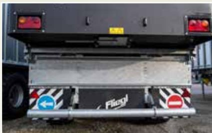
Version 40 km/h (Allemagne) avec protection anti-encastrement rigide
