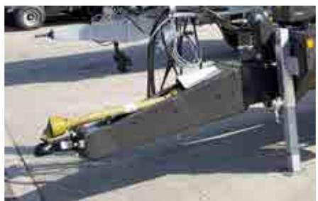
Drehbarer Zugholm für Oben- und Untenanhängung
