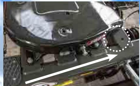
Mechanische Sattelplattenverstellung für Einachs- und Tandem-Dolly
