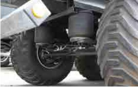
Optional: Luftfederung mit automatischer Kippabsenkung
