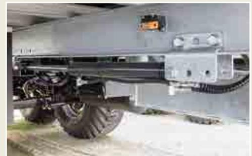
Die stufenlos hydraulische Achsverschiebung
