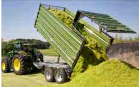
Silierkipper mit hydraulischer Rückwand
