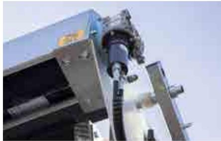
Schutzvorrichtung gegen Verschmutzung und Beschädigung
