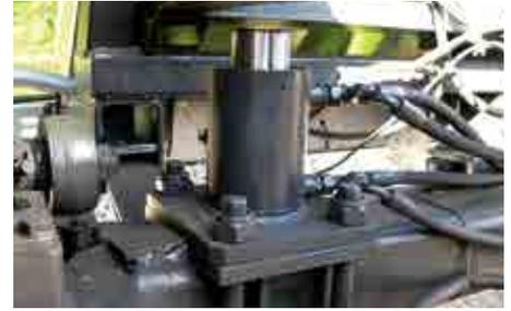
Optional: Hydraulische Abstützung auf die Achse
