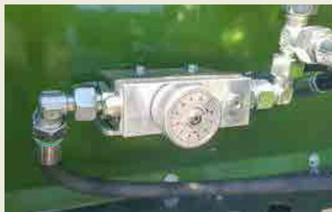
**Mechanisches Potentiometer** mit einstellbarer Vorschubgeschwindigkeit vorne an der Streuermulde
