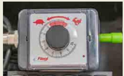
**Elektrisches Potentiometer** mit einstellbarer Vorschubgeschwindigkeit am Bedienpult
