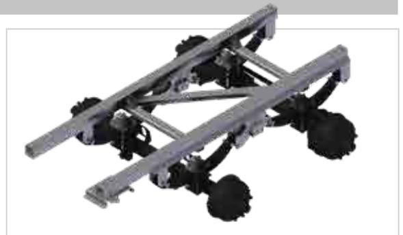
Tandemaggregat Gigant – Parabelfederung
