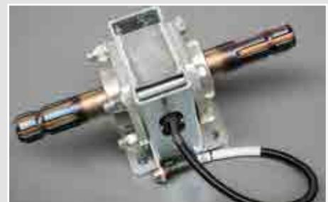
Automatische Drehmomentüberwachung mit Vorschubsteuerung „VARIO SENS“
