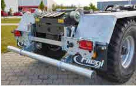
Optional: Ausziehbarer Beleuchtungsträger
