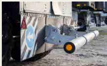
Optional: Unterfahrschutz mechanisch klappbar
