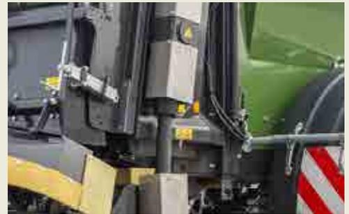
**Fräsrollenantrieb** über der Gelenkwelle
