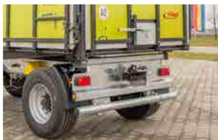
Beleuchtungsträger mit Anhängerkupplung automatisch sowie Getreideschieber
