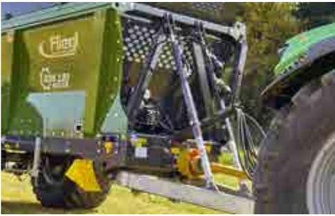
**Hydraulisch gefederte Zugdeichsel für Tiefbettstreuer / Untenanhängung.**
