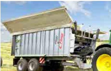
TOPLIFT: Innerhalb kürzester Zeit können die beiden Planenhälften geöffnet und geschlossen werden
