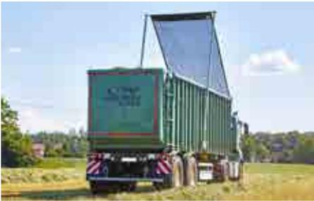
Aufziehen durch Federspannung
