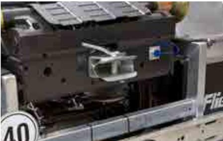
Optional: Bremsanschluß und Hydraulik für 2. Anhänger
