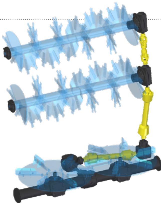
Antriebsstrang der horizontal liegenden Walzen. Überlastsicherung über Nockenschaltkupplung in Gelenkwellen zum Schlepper und Scherschraube in der Gelenkwelle nach dem Winkelgetriebe. Freilaufkupplung zwischen T-Getriebe und Streutellerantrieb
