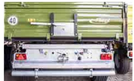
TDK 160 S mit hydr. Schotterklappe 500 mm | Brücke aus verschleißfestem Stahl 450 HB, Eckrungen verschweißt. Brücke: 5000 x 2320 x 2220 mm
