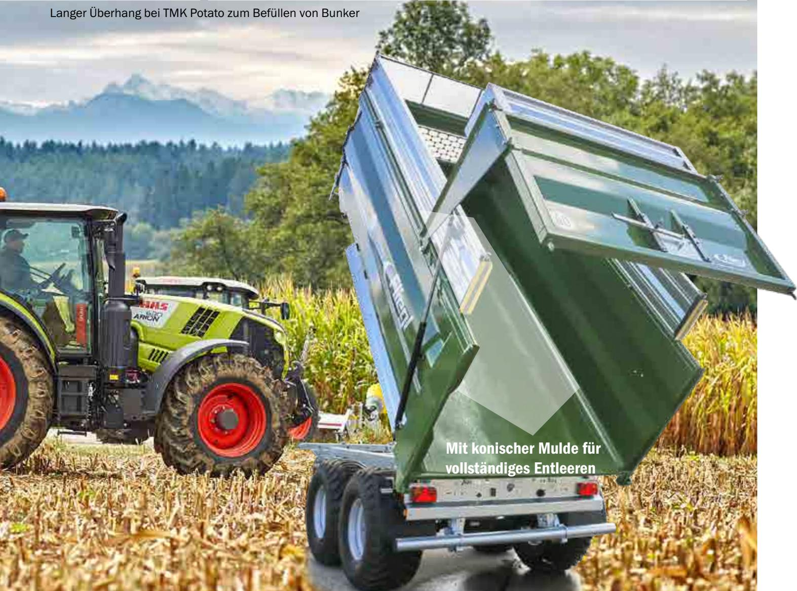
Mit konischer Mulde für vollständiges Entleeren
