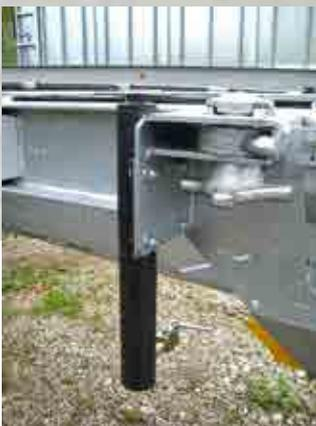
Zylinder für hydraulische Hebeeinrichtung
