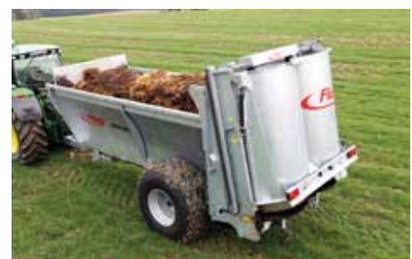
Osvědčená vhrnovací technika Fliegl posunuje materiál rovnoměrně k rozmetadlu. Po vyprázdnění je nákladový prostor téměř čistý, dno zůstává na rozdíl od použití řetězových dopravníků čisté.
