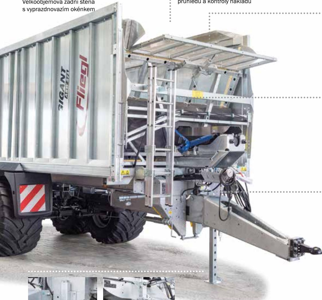
Hydraulické odpružení oje od modelu ASW256 GIGANT – výška závěsu plynule nastavitelná
