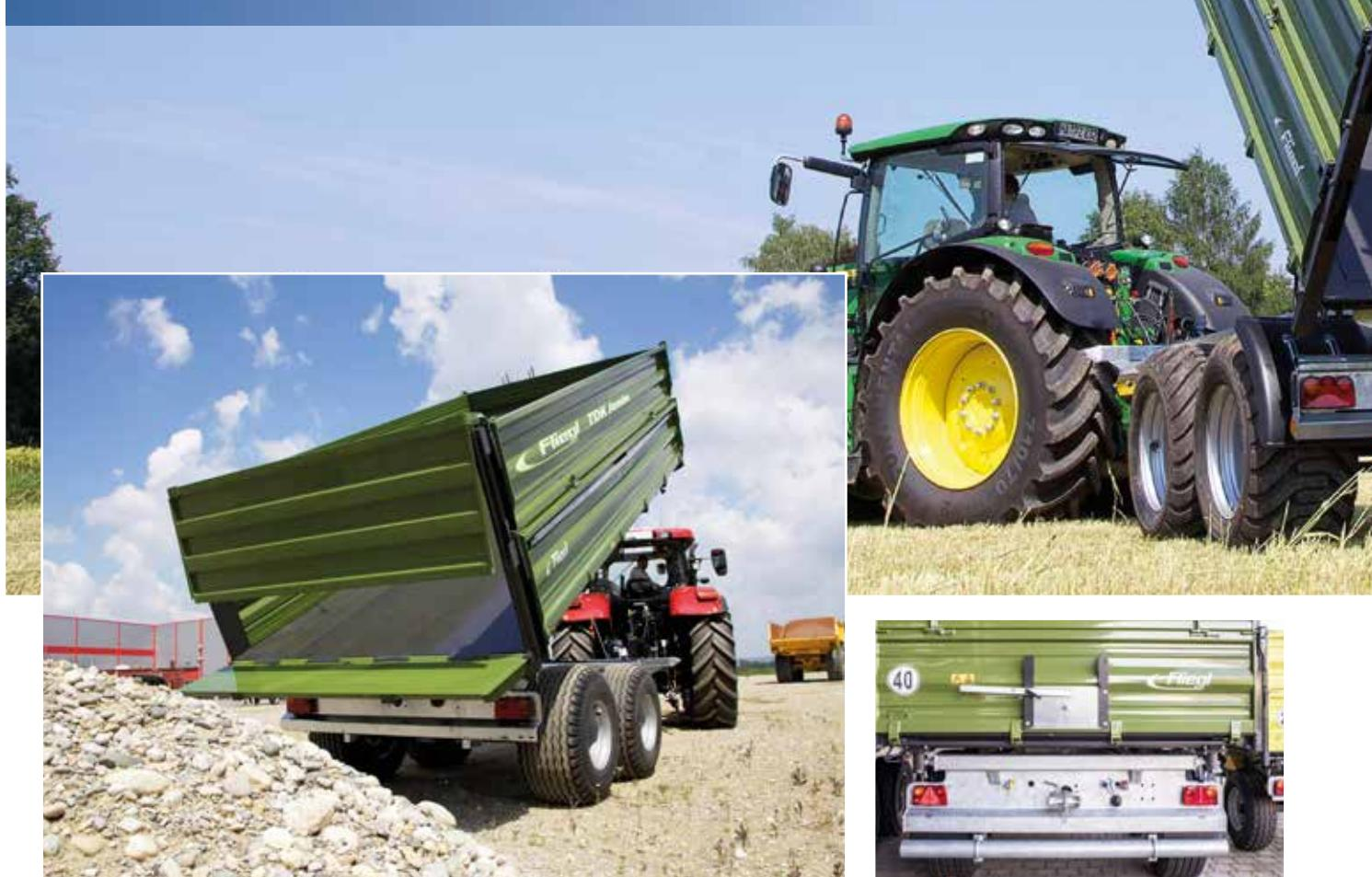
TDK 160 s hydraulickou štěrkovou klapkou 500 mm
