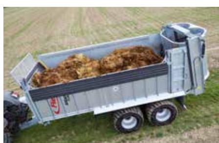
Mechanické odklápení bočnic – volitelně vlevo nebo vpravo
