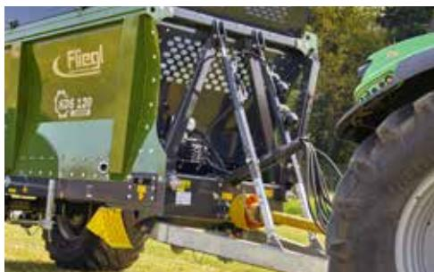
Hydraulicky odpružená tažná oj pro rozmetadlo s nízkou ložnou plochou / dolní zavěšení. Výšku závěsu je možné pohodlně nastavit.
