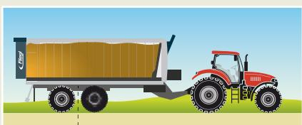
Optimální úprava zatížení pomocí mechanického (sériová výbava) nebo plynulého hydraulického posouvání náprav (volitelné)
