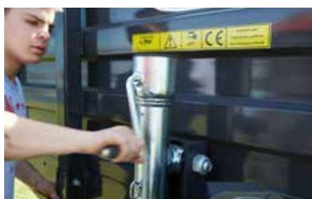
Tažná oj s vřetenovým nastavením
