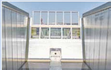
Těsnící lišty: Nákladový prostor dokonale utěsňují polyuretanové lišty namontované speciálně pod úhlem 45°.
