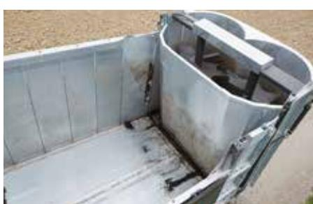
Kompletně pozinkovaná akumulační klapka - gilotina je instalována sériově. Uložení rozmetadla je bezúdržbově dostupné pomocí lišty centrálního mazání.
