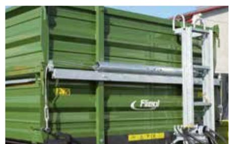
Volitelně: Tažná pružina bočnic v těžkém provedení
