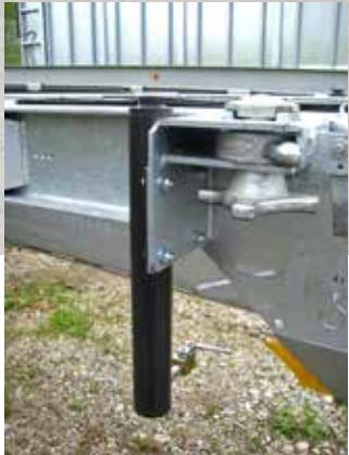
Válce pro hydraulické zvedací zařízení
