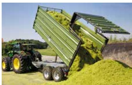
Silážní sklápěč s hydraulickou zadní stěnou
