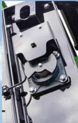
**Volitelné příslušenství: Elektronické sledování otáček** monitoruje rychlosť míchacích válců a v případě potřeby automaticky vypíná podlahový řetězový dopravník materiálu, aby tak byl celý systém optimálně chráněn před poškozením cizími tělesy.
