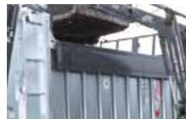
Mechanické sklápění bočnic
