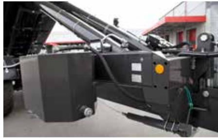
Hydraulika 60 litrů (volitelně 90 l) poháněná vývodovým hřidelem s hydraulickým
