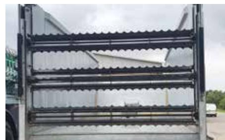
Dávkovací válec se 3 ležatými frézovacími válcí
