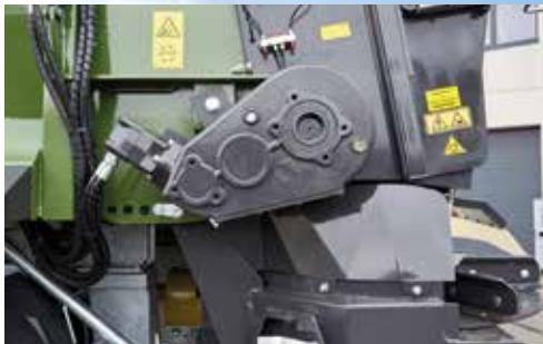
Silné boční převodové ústrojí na hřídeli 60 mm zajišťuje rovnoměrný posuv materiálu
