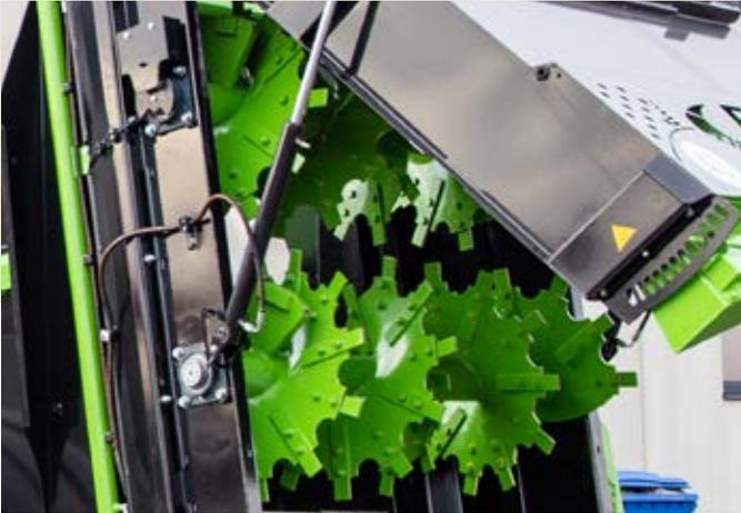
Die **2 Mischwalzen** mit einem **Ø von je 770 mm** sind beidseitig in die Mitte gewunden und mit geschraubten Messerzinken aus verschleißfestem Stahl HB 400 bestückt. Sie sind für jedes Streugut bestens geeignet.
