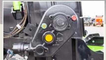
Schweres seitliches Getriebe sorgt auf einer 60er Welle für einen gleichmäßigen Materialvorschub
