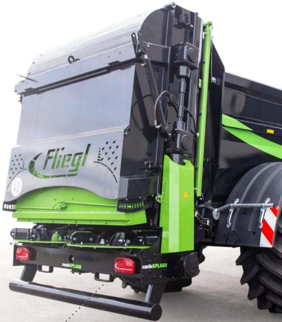
Optionale **Voll-LED Rückleuchte** „Dynamic“ mit dynamischem Blinker aus schlagfestem Material
