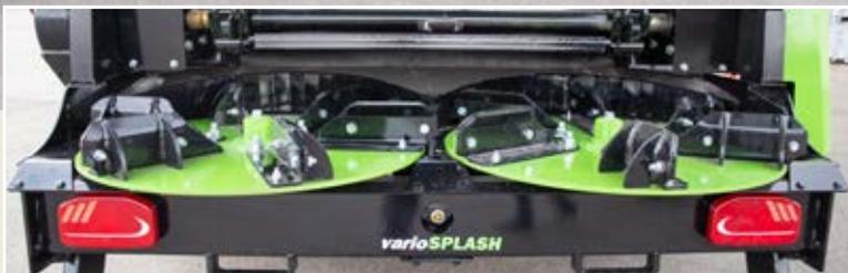
**Tellerstreuwerk varioSPLASH** zwei große Streuteller aus verschleißfestem Stahl HB 400 mit jeweils 950 mm Ø mit je 6 quer zum Wurfwinkel verstellbaren Wurfflügeln mit auswechselbaren Platten aus verschleißfestem Stahl HB 400 und ausliegenden in ihrer Sensibilität individuell auslegbaren Sicherungsbolzen.
