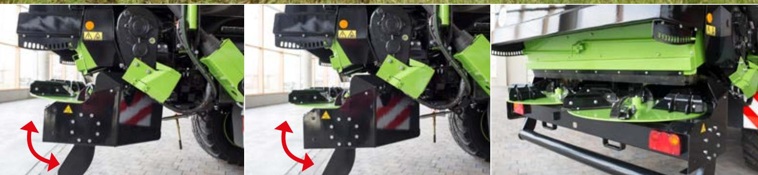
**Tellerstreuwerk varioSPLASH** zwei große Streuteller aus verschleißfestem Stahl HB 400 mit jeweils 1100 mm Ø mit je 6 quer zum Wurfwinkel verstellbaren Wurfflügeln mit auswechselbaren Platten aus verschleißfestem Stahl HB 400 und ausliegenden in ihrer Sensibilität individuell auslegbaren Sicherungsbolzen. Der Streuwinkel der Teller ist im Winkel mechanisch optional auch hydraulisch verstellbar (Tandem/Tridem). **Arbeitsbreite von bis zu 30 Meter je nach Streugut möglich.**
