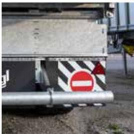
La protection anti-encastrement se rabat automatiquement vers le haut lors de l'ouverture de la large paroi arrière
