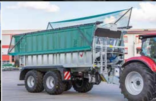
Filet de recouvrement rabattable sur le côté
