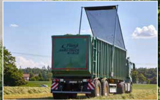
Déploiement par tension de ressort
