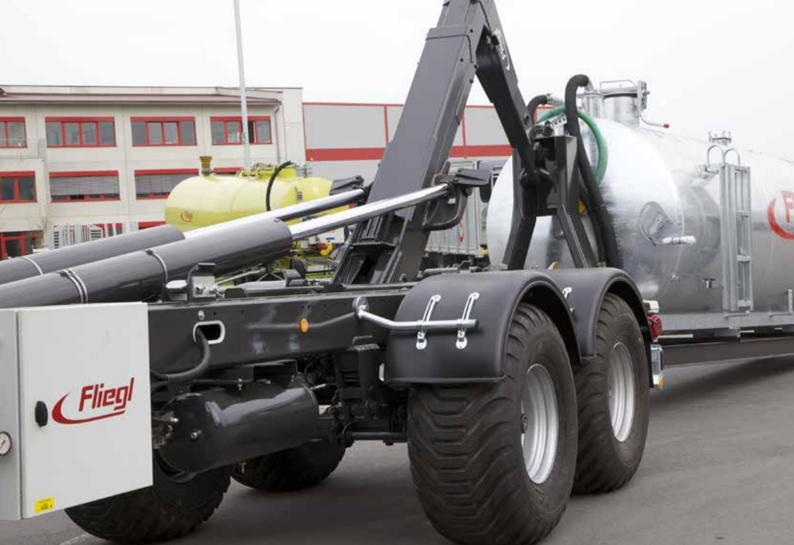
Crochet de montage forgé, pouvant être remplacé facilement
