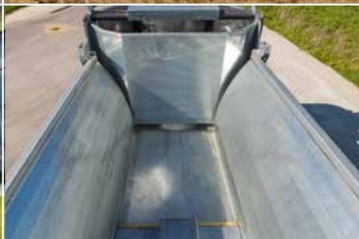
Très faible usure grâce au système de poussée hydraulique – pas de fond racleur.
