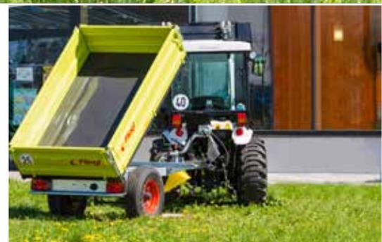
Remorque tri-benne basculante à un essieu adaptée à toutes les tailles de tracteur
