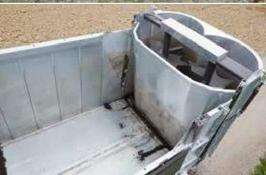
Le couloir de stockage entièrement galvanisé est monté de série. Les paliers de l'épandeur sont faciles d'entretien et sont accessibles via une barre de lubrification centrale.
