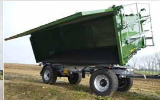
Benne monocoque à trois côtés tandem extrêmement robuste grâce à sa paroi latérale renforcée
