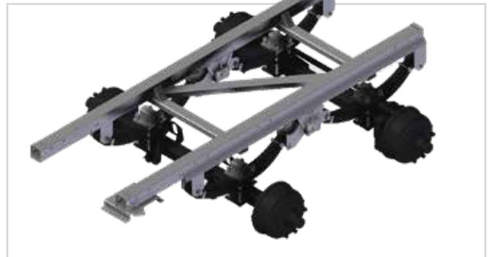
Châssis tandem Gigant – suspension à ressorts paraboliques
