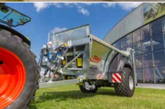
Suspension de timon hydraulique, meilleur confort de conduite
