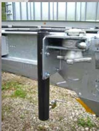
Cylindre pour dispositif de levage hydraulique
