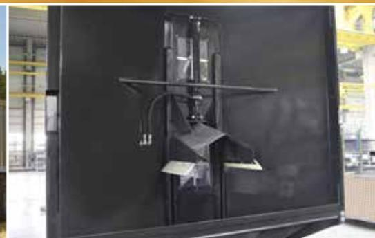
Le coulisseau de stockage hydraulique permet de vider entièrement la vis de transbordement à l'état chargé
