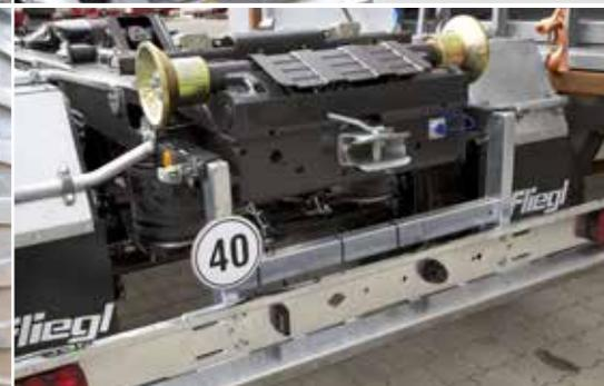
En option : support hydraulique sur l'essieu
