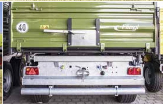
Benne d'ensilage avec paroi arrière hydraulique
