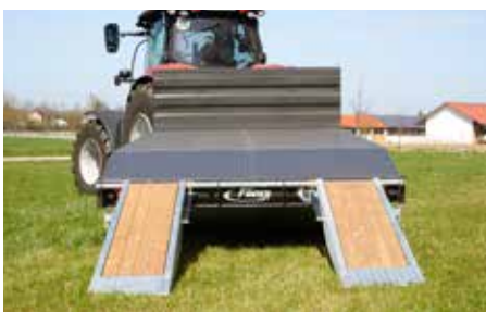
Tylnia część platformy, na długości 900 mm, obniżona pod skosem; dla wygodniejszego załadunku
