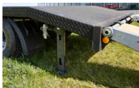
Usztywnienie tylnej części platformy 2-ma nogami podporowymi
