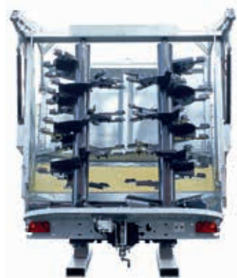
Wały tnąco-rozdrabniające z łopatkami wyrzutowymi
