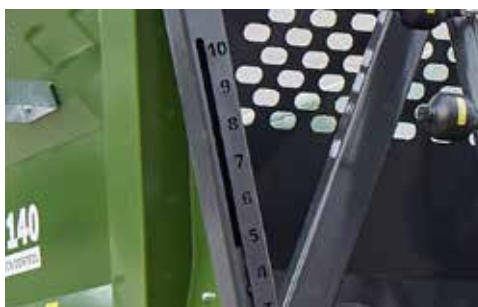
Wskaźnik pozycji łańcucha wewnętrznej
