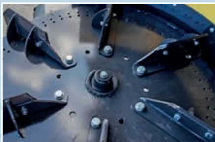
Regulacja łopat wyrzutowych
