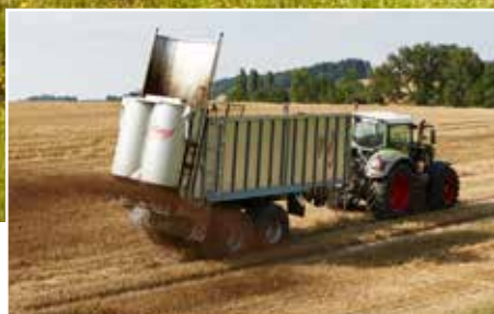
ASW z adapterem PROFI V2: talerze wyrzutowe zintegrowane z wahliwymi łopatkami
