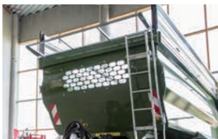
Mechanicznie regulowana przednia kratownica
