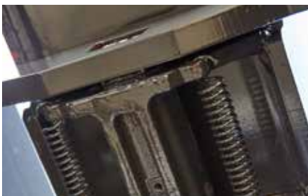
Automatyczna blokada na hak podczas operacji wyładunku
