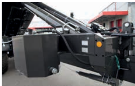
Układ hydrauliczny 60 litrów (opcjonalnie 90 l) napędzany wałem przekładnika mocy wraz z pompą hydrauliczną i zbiornikiem oleju
