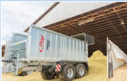
Zsuwanie a nie wywracanie - bezproblemowe w przypadku niższych budynków.
