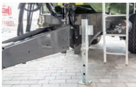
Od modelu TMK 256 seryjnie: dyszel amortyzowany hydraulicznie i noga podporowa mechaniczna
