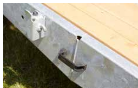
Rampa najazdowa wypełniona profilami z drewna; platforma malowana z blachy stalowej 3,5 mm dla TPA 120
