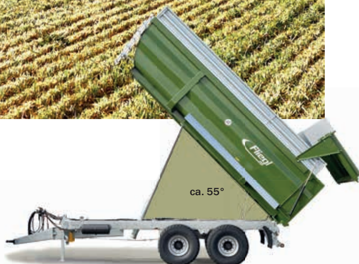
Przyczepa skorupowa TMK 269 z skrzynią o długości 6,90 m oraz siłownikiem o max. kącie wywrotu ok. 55°
