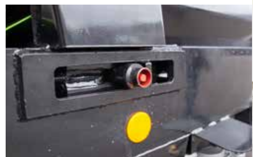
Łatwy dostęp do punktów konserwacyjnych przenośnika łańcuchowego
