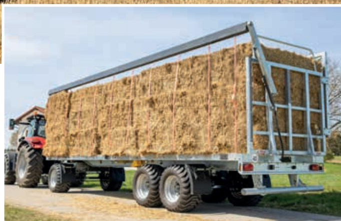
DPW 210 Ultra z zabezpieczeniem ładunku w pozycji zamkniętej; lewo- lub prawostronny wybór strony zabezpieczenia
