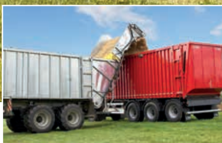
Taśma przeładunkowa „MOBILFAST” (max. wyładunek do 30 m 3 /min)
