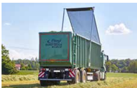
Naciąganie poprzez system sprężyn
