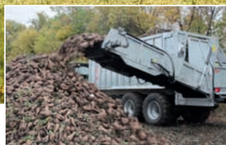
RUBY do przeładunku buraków cukrowych o max. wydajności ok.: 15 m 3 /min
