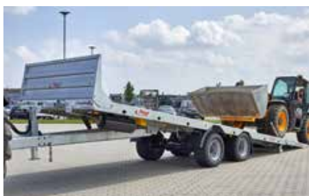
Dyszel regulowany hydraulicznie - od modelu TPA 200
