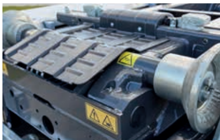
Rolki prowadzące stalowe ( \varnothing 310\text{mm} ), odlewane z dużymi stożkami centrującymi – szczególnie ułatwiają „wciąganie” kontenera
