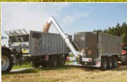
Żmijka przeładowcza ÜLS 400 z max. wydajnością przeładunku do ok. 7,5 t/min
