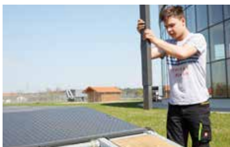
Kłonicę narożną demontowaną - dla łatwiejszego załadunku
