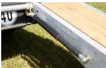
Rampa najazdowa składana podnośnikiem sprężynowym; opcjonalnie: hydraulicznie
