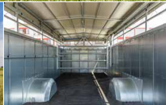
Verstelbaar scheidingsrooster en bodem uit geribbeld staal met afvoeropening
