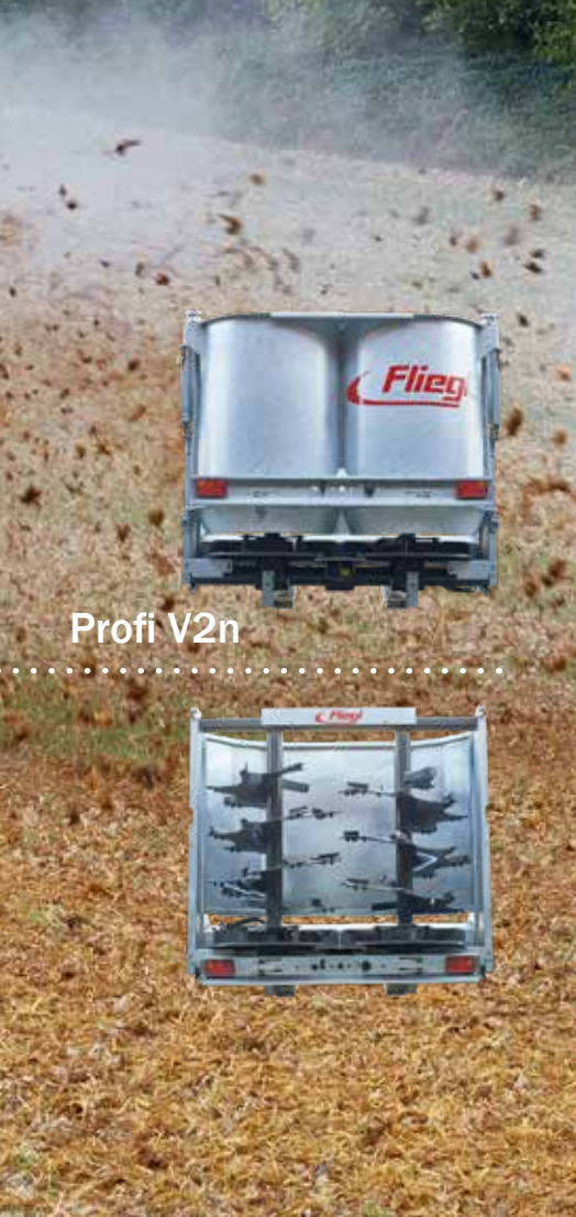
Strooier "Profi V2" met gesloten breedstrooiachterwand
