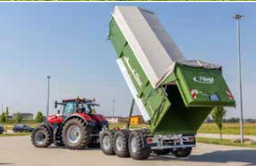
De TMK 373 Profi met een baklengte van 7,30 m
