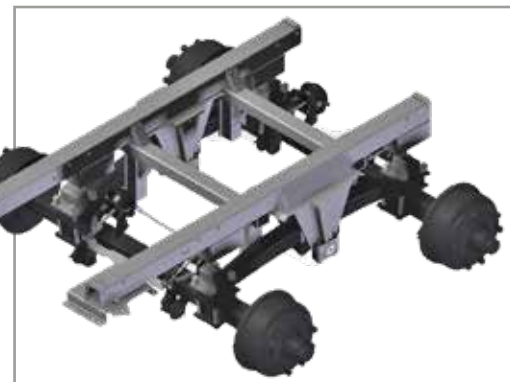
Met Titan onderstel in tandemmassige uitvoering voor optimale compensatie van bodemoneffenheden.
