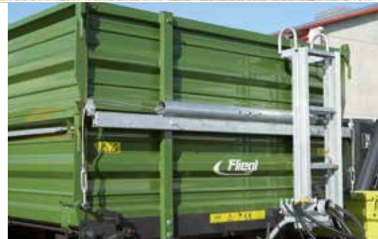
Optie: Schotwandtrekveren in zware uitvoering
