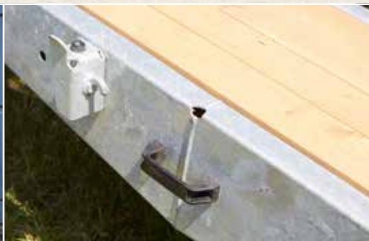
Opritten met houten bovenlaag, brugbodem uit staalplaat 3,5 mm gelakt bij de TPA 120
