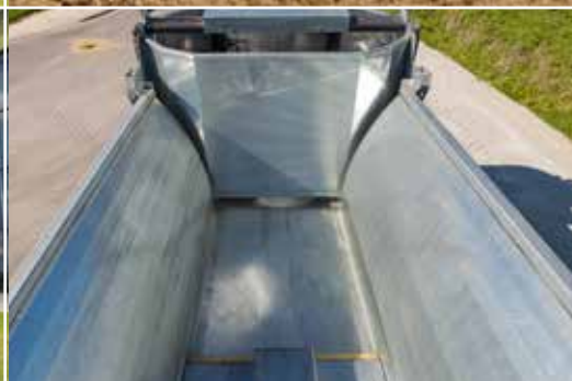
Geringste slijtage door het hydr. schuifstelsel – geen schraapbodem.
