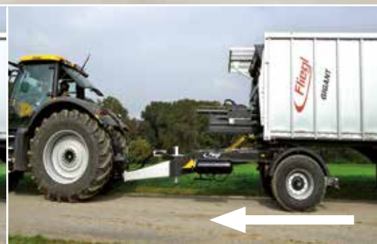
Hydraulische opleggerplaatverstelling voor dolly in eenassige en tandmassige uitvoering
