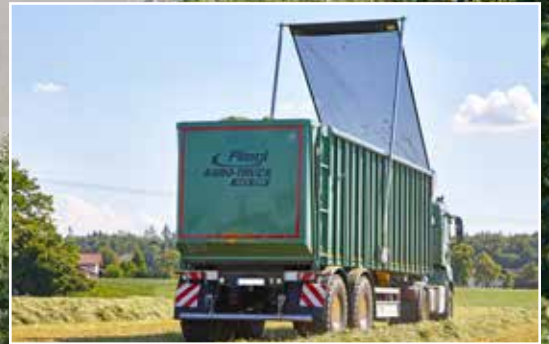
Optrekken door veerspanning
