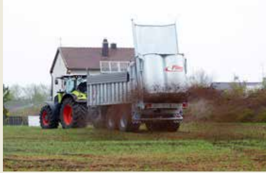
Strooier "Profi V2" met gesloten breedstrooiachterwand
