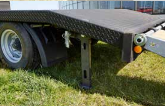
Boven: Opritten standaard met veerheffer en als optie ook hydraulisch verkrijgbaar
