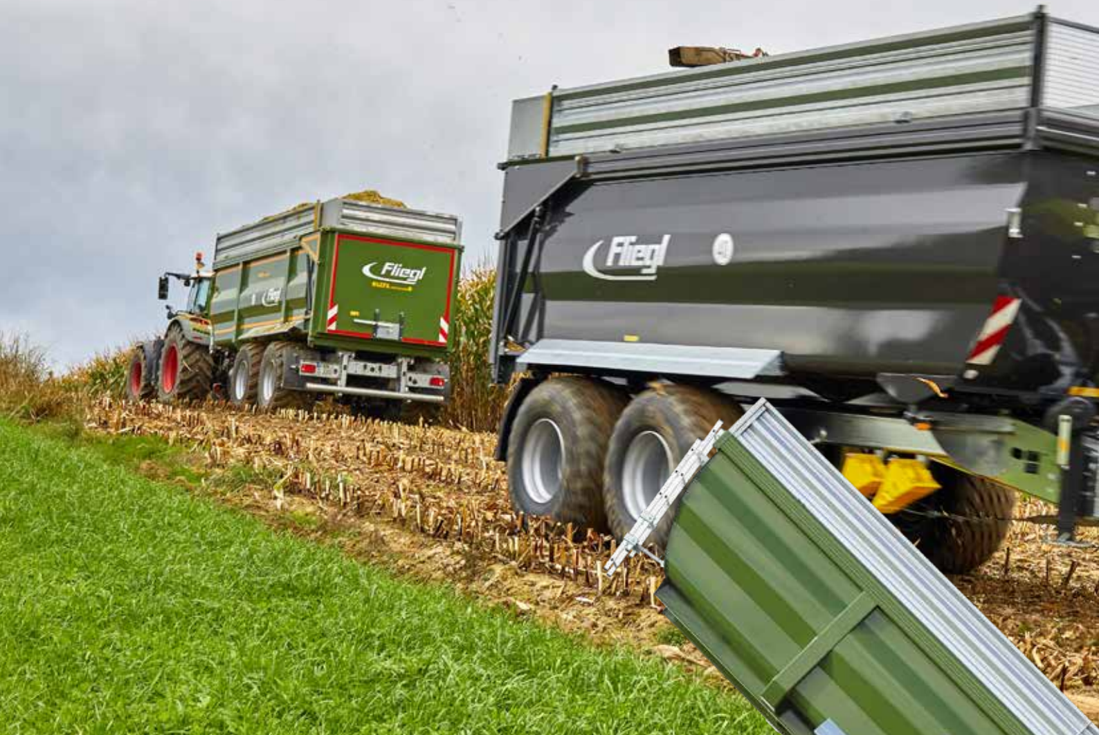
De tandemmasser TMK 269 Profi met een baklengte van 6,90 m en een kiephoek van ca. 55°
