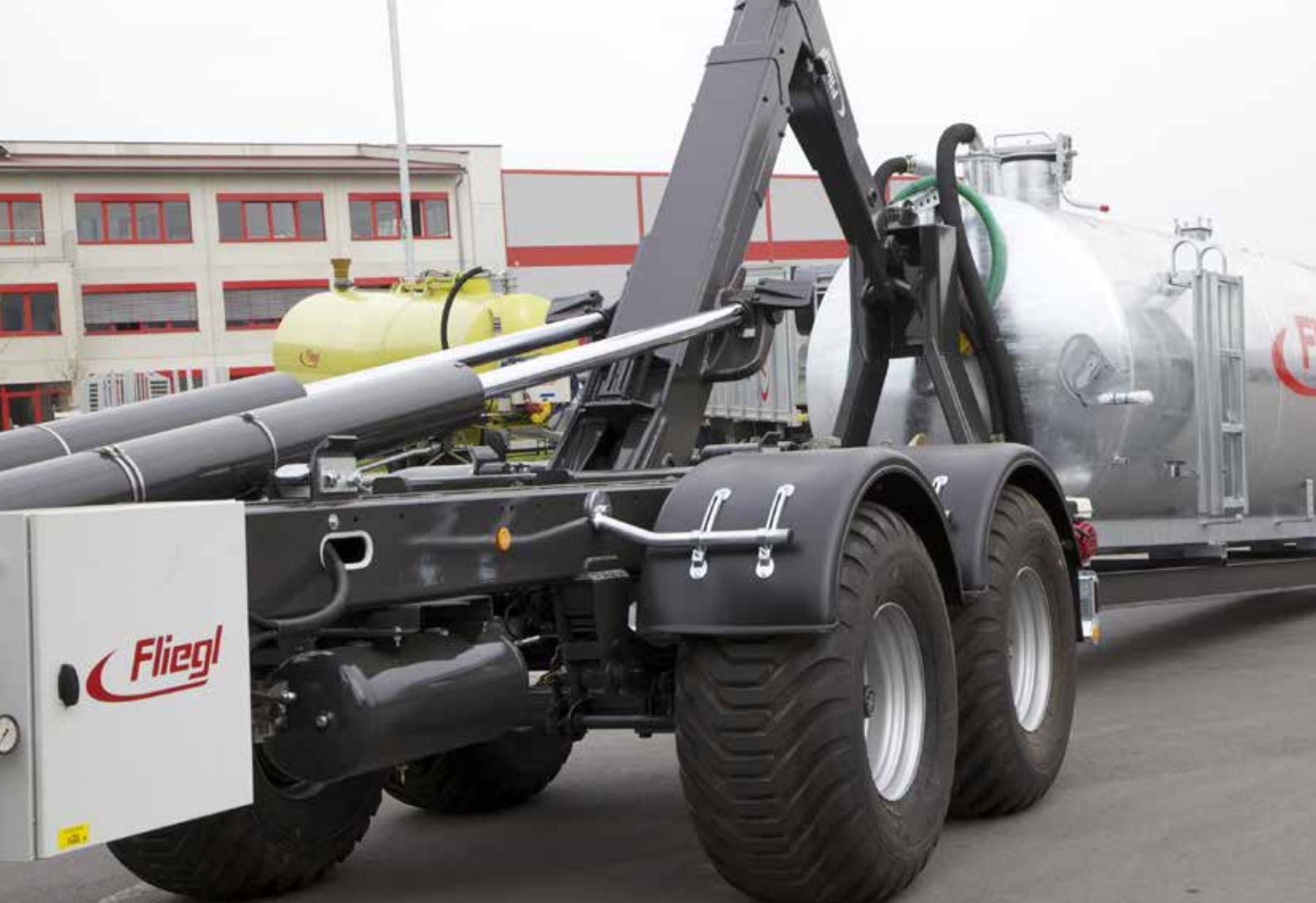
Gesmede, eenvoudig uitwisselbare opnamehaak
