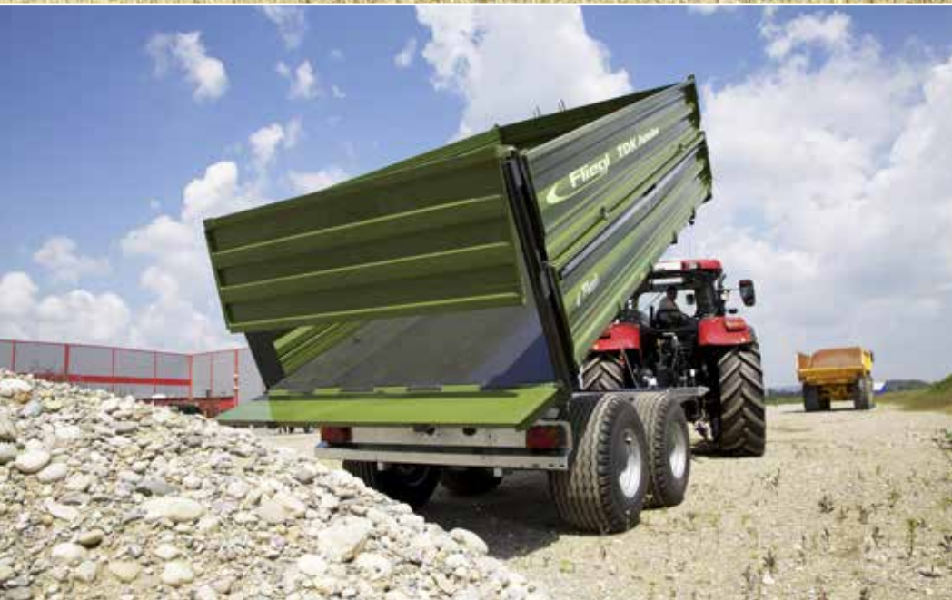
TDK 160 met opbouw 1800 mm (3 x 600 mm schottenwand)
