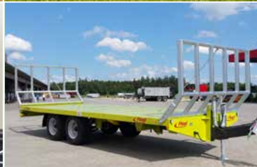
Tandemmassige platformwagens met balenrooster en speciale laklaag (optie)
