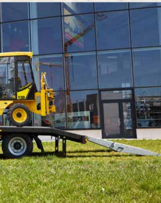
Opritten met houten bovenlaag, brugbodem uit staalplaat 3,5 mm gelakt bij de TPA 120
