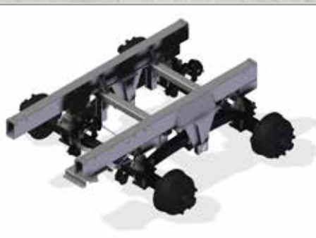
Met Titan onderstel in tandmassige uitvoering voor optimale compensatie van bodemoneffenheden
