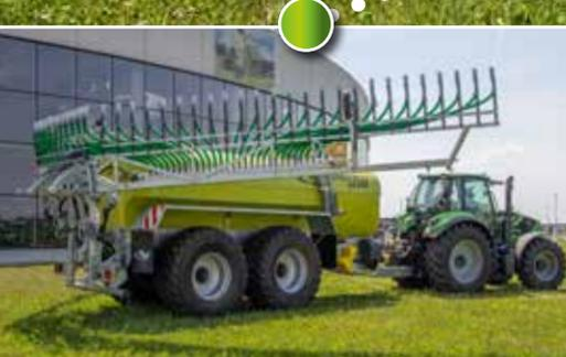
Keine abknickende Auslaufschläuche durch speziellen Klappmechanismus
