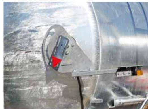
Füllstandsanzeiger mit Schwimmerkugel
