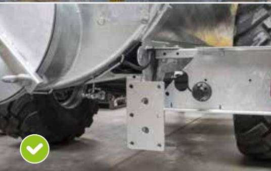
Anbaukonsole für Schlepschlauch- oder Schlepschuhverteiler SERIE ab 5000L
