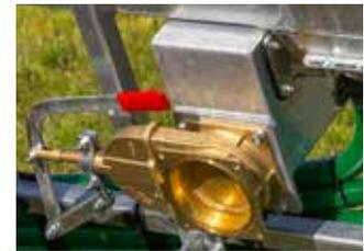
Staukasten zum separieren von Fremdkörpern
