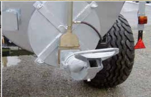
Kombiverteiler – klappbar
