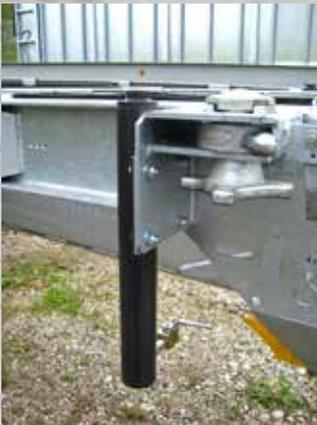
Zylinder für hydraulische Hebeeinrichtung
