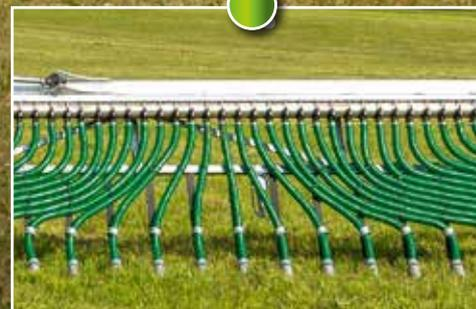
Gleichmäßige Verteilqualität durch kurze Auslaufschläuche
