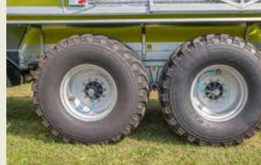
Reifendruckregelanlage für bodenschonenden Feldeinsatz mit und Zweileiteranlage
