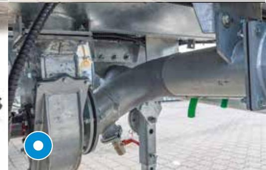
Turbobefüller hydraulisch, mittig unter dem Fass
