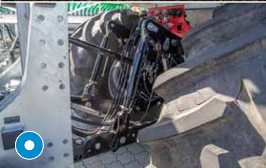
Dreipunkthydraulik wird beim Lenken der Achse mitgeführt
