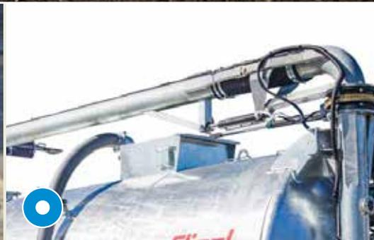
Absaugarm hydraulisch schenkbar 8"
