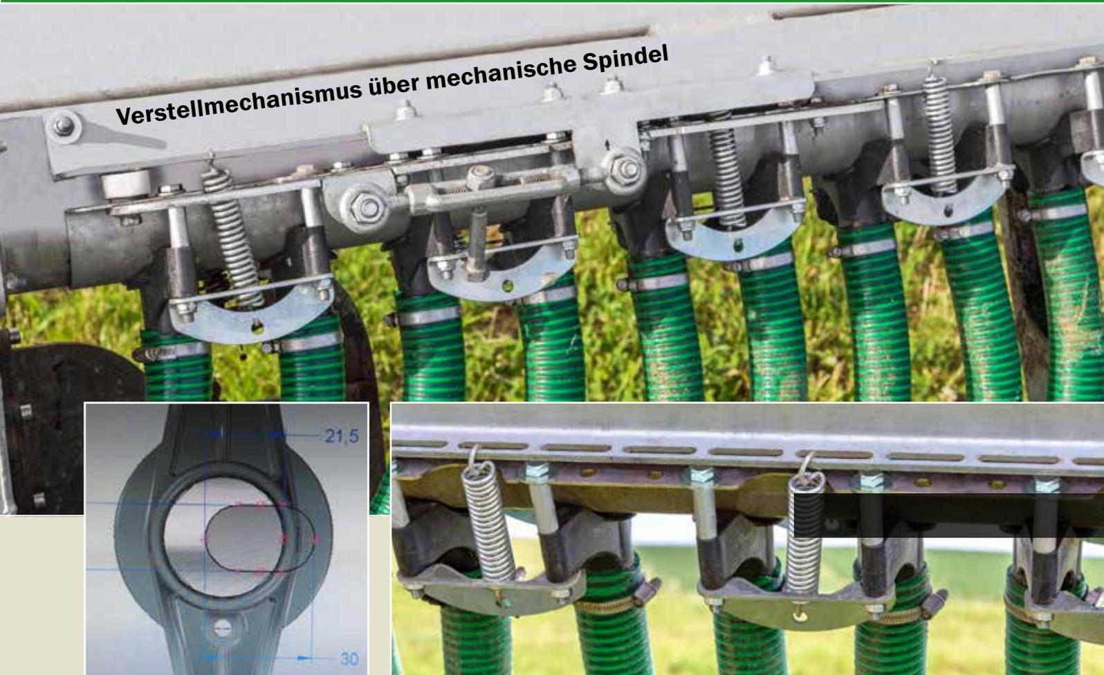
Federspannvorrichtung des Schneckenverteilers FlexFlow
