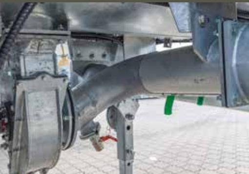
**Turbobefüller mittig unter Fass**
