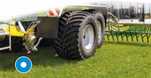
Teleskopachse (nur bei Pendelaggregat Boogie SB möglich)
