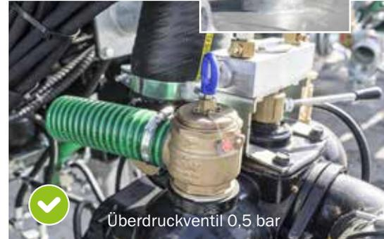
Überdruckventil 0,5 bar
