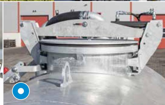
Hydraulischer Einfülldom (400 mm oder 600 mm)
