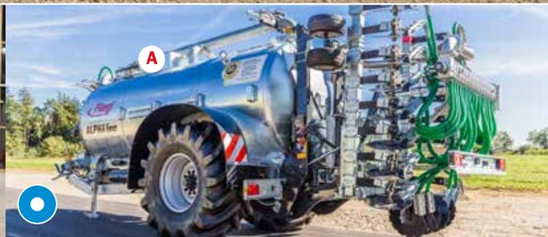
**A: Absaugarm** 4500mm Länge, beidseitig schwenkbar
