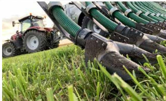
Fliegl TWIN ist eine Y-förmige Schleppschuhdüse. Sie splittet den Güllefluss, halbiert so die Güllemenge pro Gülleband und verdoppelt gleichzeitig die abgelegten Güllebänder.
