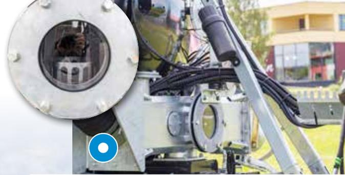
Pumpkasten mit Schauglas und Fremdkörperabscheider
