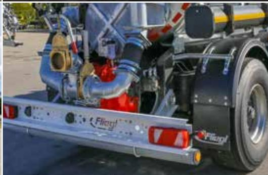
in Pumpausführung mit Vogelsang-Drehkolbenpumpe
