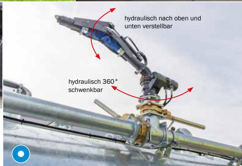
hydraulisch nach oben und unten verstellbar
