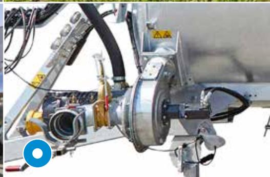
Turbobefüller seitlich links oder rechts möglich
