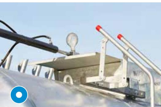
Bei Pumpfass: Hydraulischer Schubdeckel
