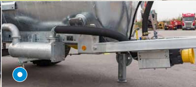
Ab 5000 Liter mit gekröpfter Achse: Niedriger Schwerpunkt sorgt für optimales Fahrverhalten am Hang
