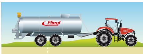
Optimale Anpassung der Stützlast durch mechanische Achsverschiebung (Serienausstattung) oder stufenlos hydraulisch (optional). Auch bei Montage von Gülleverteiltern wie z.B. Schleppschuh
