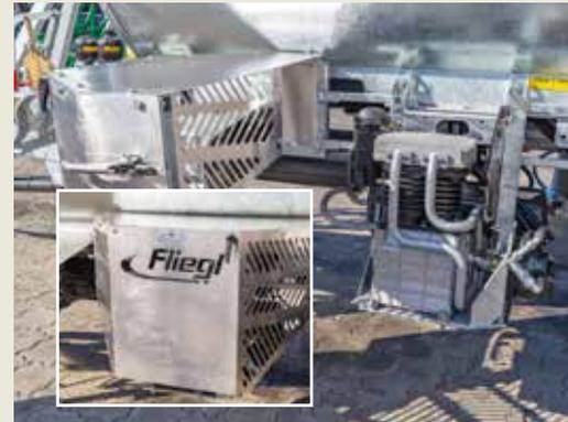
Kolbenkompressor mit bis 3,3 m<sup>3</sup> Luftleistung
