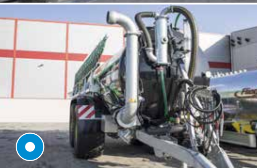
Zuigslang – links of rechts – voor handig aanzuigen
