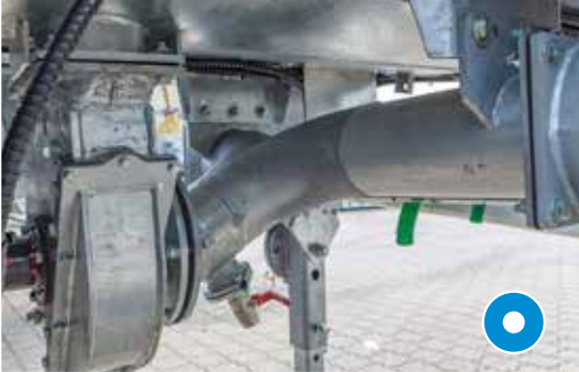
Bij vacuümtank: Turbovuller midden onder de tank
