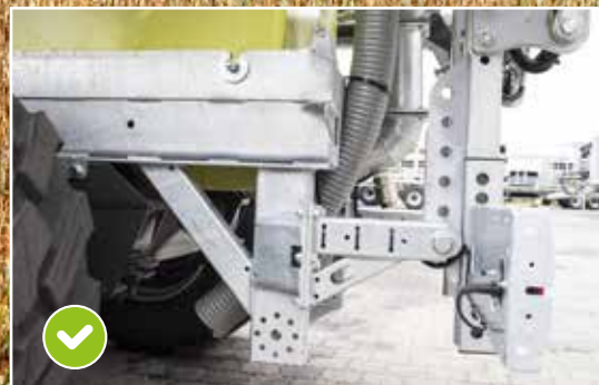
Aanbouwconsole voor sleepschoenverspreider en vierpuntshydrauliek
