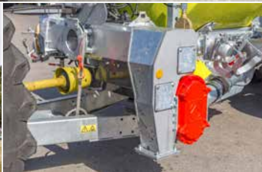
Roadx Poly Line met mechanisch aangedreven draaizuigerpomp voor het aanzuigen
