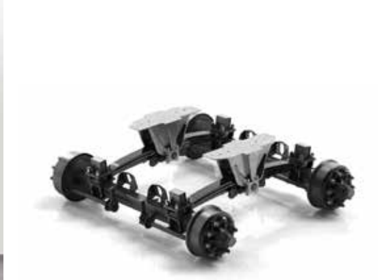
Titan tandemmassige constructie voor optimale compensatie van bodemoneffenheden
