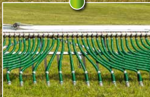
Gelijkmatige verspreidingskwaliteit door korte uitlooslangen
