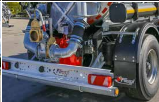
in pompuutvoering met Vogelsang draaizuigerpomp
