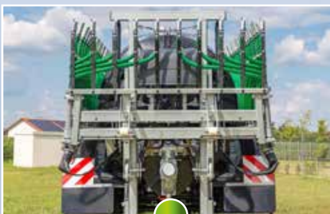
Extreem compacte transportbreedte van onderen 2600 mm en boven 2300 mm
