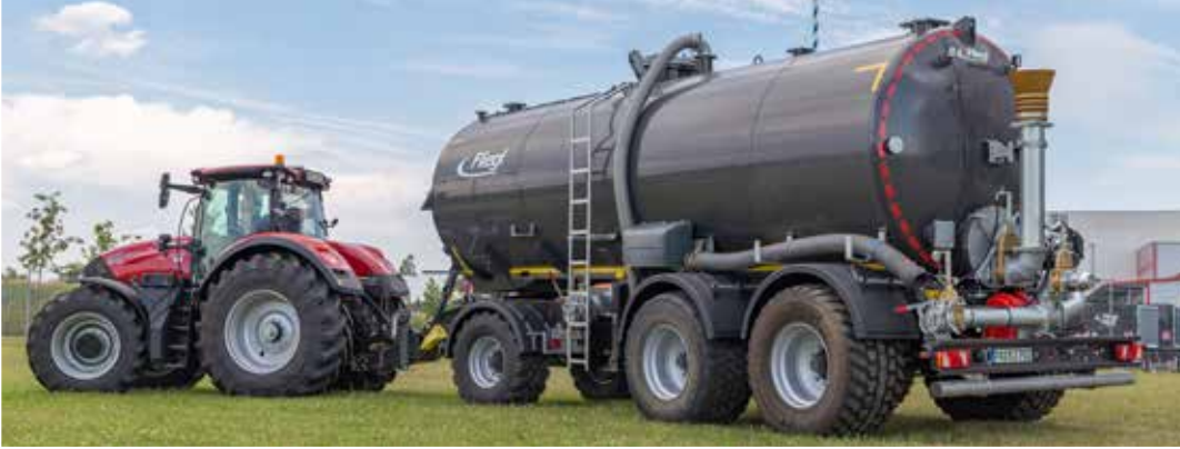
Opleggertransporttank STF 27500 met geïntegreerde dolly
