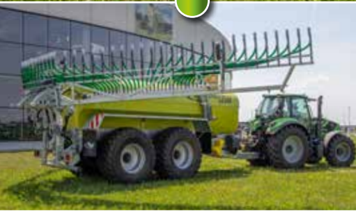
Geen geknikte uitloopslangen door speciaal opklapmechanisme
