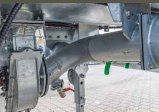
Turbovuller midden onder de tank
