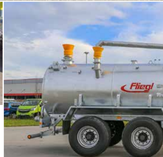
Road X Line 16.000 tandemmasser met centrifugaalpomp en overlaadarm, naar beide zijden zwenkbaar
