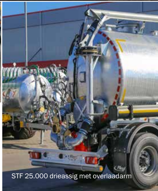
in pompuutvoering met Vogelsang draaizuigerpomp
