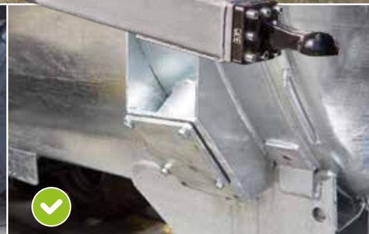
Standaard blinde flens Rechts- en linksvoor alsmede achter
