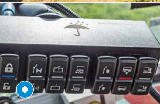
Bedieningspaneel voor tank + verspreider Afbeelding: rood knipperlicht dat de pomp tegen drooglopen beschermd
