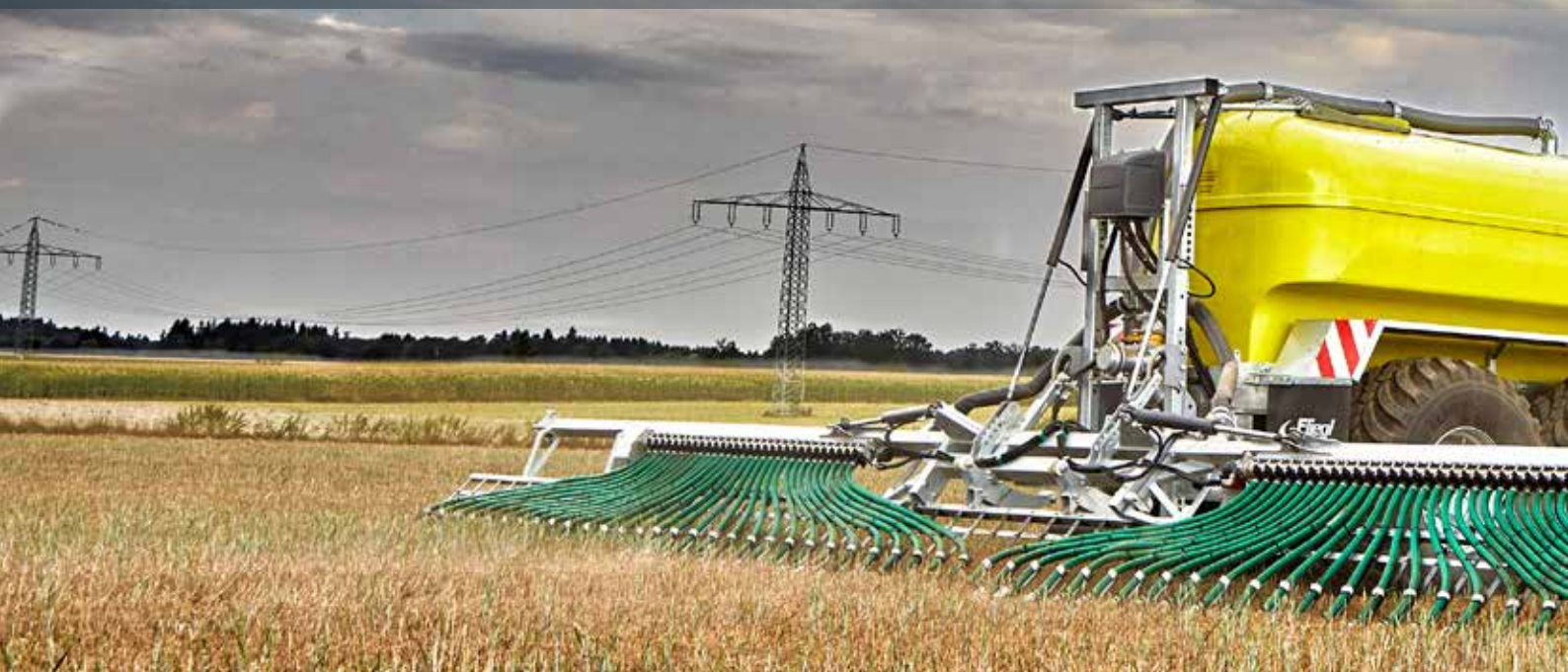
Aanbouwconsole voor sleepschoenverspreider en vierpuntshydrauliek
