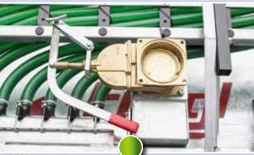
Mechanisch of hydraulisch openen van verzamelbak
