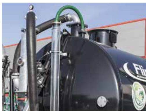
Plexiglas fill level indicator
