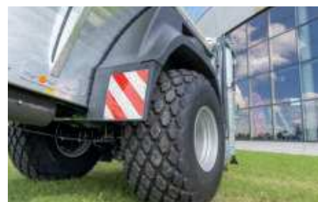
Opcionális: 40 km/h-ás kivitel sárvédővel ADS 80 / ADS 100 / ADS 120 esetén
