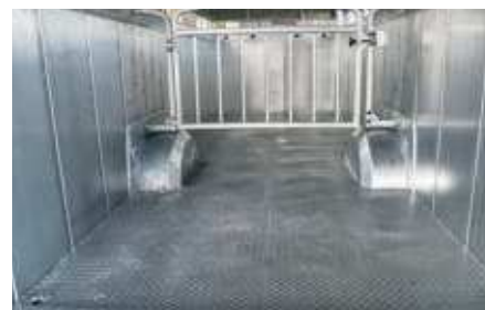
A bordázott acéllemez stabil állást biztosít az állatoknak.
