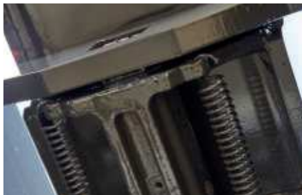
Automatikus horogzár billentéskor
