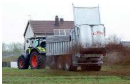
»Profii V2« szórószerkezet zárt, szélesszóró hátfallal
