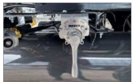
Emelő és süllyesztőszelep légrugózásál
