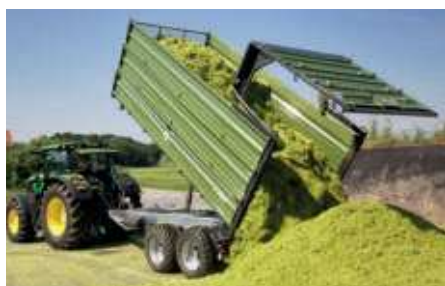
Silószállításhoz billentő pótkocsi hidraulikus hátfallal
