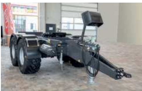
Tandem Dolly 17 tonna nyeregterheléssel és 20 tonna össztömeggel
