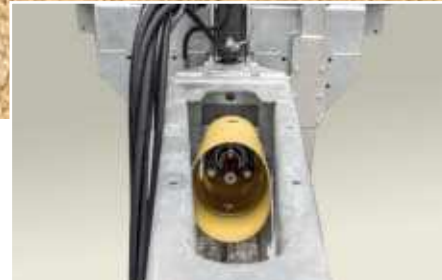
Kardánhajtás az adapterek meghajtásához
