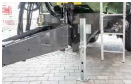
Hidraulikus rugózású vonórúd, mechanikus támasztólábbal TMK 256-tól
