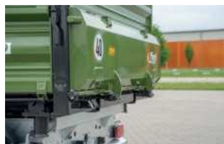
Erősített hátfal két munkahengeres kivitel
