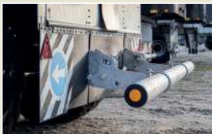
Opcionális: mechanikusan felhajtható aláfutásgátló
