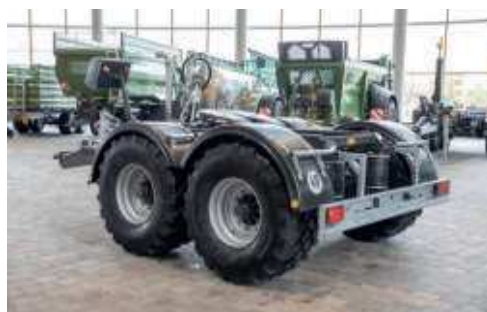
Tandem Dolly 17 tonna nyeregterheléssel és 20 tonna össztömeggel
