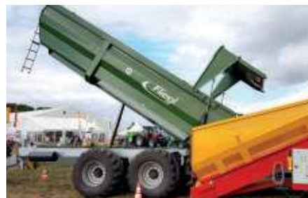
Hosszú kinyúlás a bunkerbe ürítéshez
