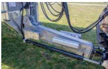
Opcionális: hidraulikus kényszerkormányzás
