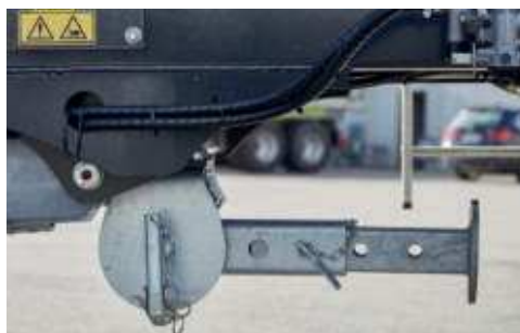
Állítható támasztóláb Hátra hajtható a nagyobb stabilitás érdekében.
