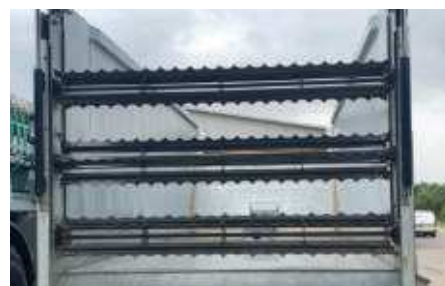
Szórószerkezet 3 db fekvő lazítóhengerrel
