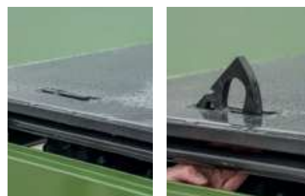
Platóba integrált kikötőszem
