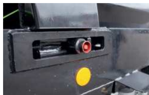
Kényelmesen hozzáférhető, kenhető, kétoldali láncfeszítő
