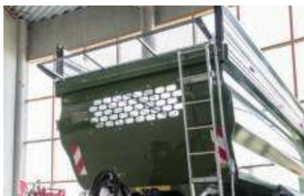
Mechanikusan behajtható védőrács
