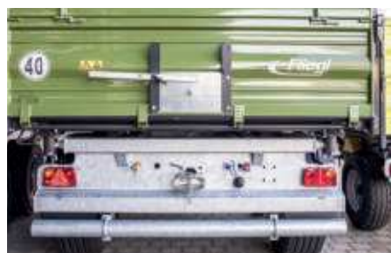
40 km/h kivitel aláfutásgátlóval és sárvédővel
