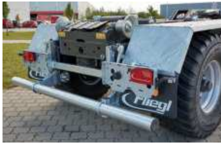
Opcionális: kihúzható lámpatartók
