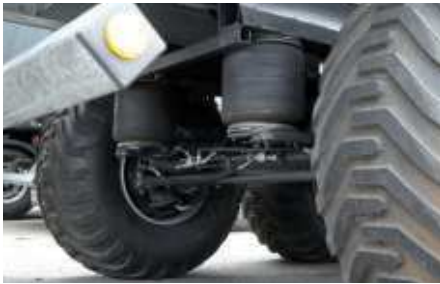
Opcionális: automata légrugózás-süllyesztés billentéskor
