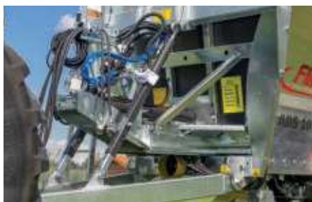
Hidraulikus vonórúdrugózás, legjobb vezetési kényelem
