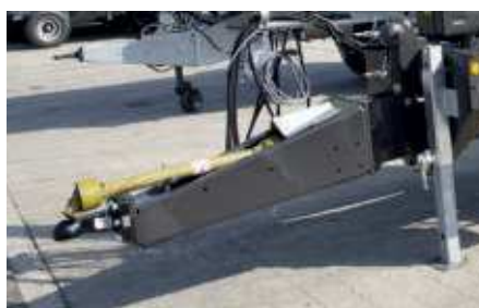
Megfordítható vonórúd a felső- és alsókapcsoláshoz
