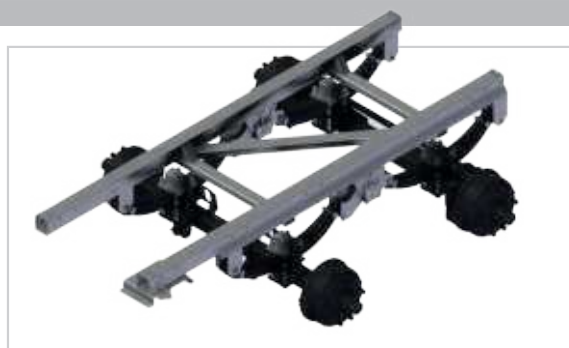
Gigant tandem futómű - parabolarugózás
