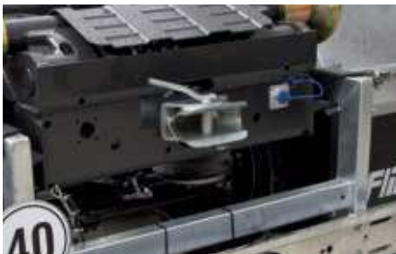
Opcionális: Fék- és hidraulikacsatlakozás második kocsii vontatásához
