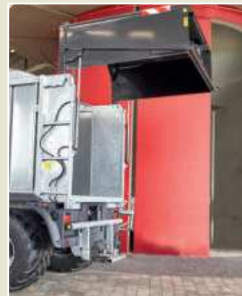
Hidraulikusan felhajtható aláfutásgátló: A hátsó ajtó nyitásakor az aláfutásgátló automatikusan felcsukódik.
