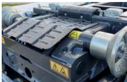
Nagy öntöttvas görgők (ø 310 mm), melyek a vezetőperem segítségével megkönnyítik a konténer felvételét.
