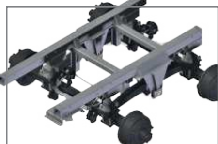
»Titan« tandem futómű a legjobb talajkiegyenlítésért
