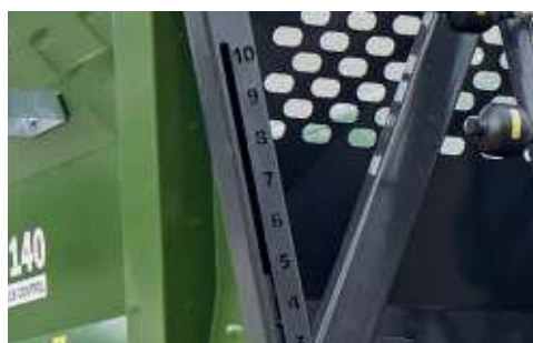
Zsilip nyitását jelző skála a homlokfalon a nyitási pozíció gyors és optimális megállapításához
