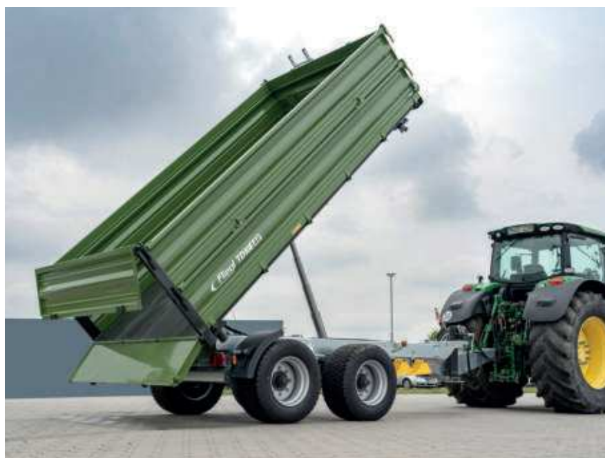
500 mm-es hidraulikus kavicsurrantós hátfal
