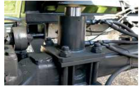
Opcionális: hidraulikus támasztás a tengelynél
