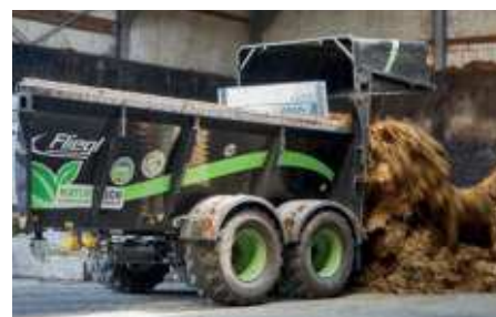
Az ADS opcióként 800 mm mély hátsó ajtóval felszerelhető és pótkocsiként használható.
