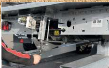
Az automatikus letolásszabályozással beállítható a letolási sebesség
