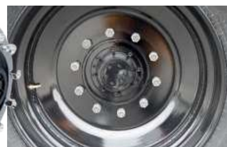
Radiáldugattyús hidromotor biztosítja a további hatásteljesítményt
