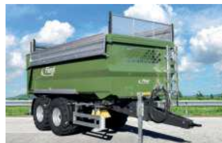
Lehajtható, horganyzott magasító
