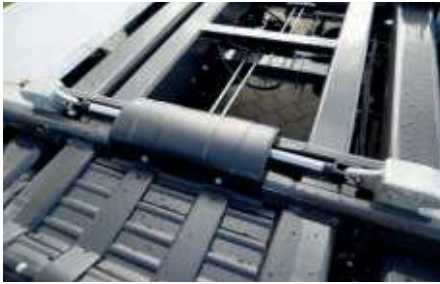
Áthelyezhető zárszerkezet a külső és belső rögzítéshez
