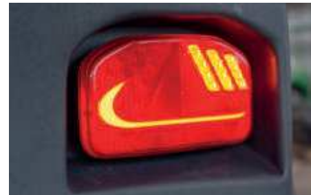
„Dynamic“ LED-es hátsó lámpa, mozgófényes irányjelző-funkcióval, ütésálló anyagból
