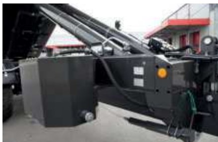
60 literes (opcionálisan 90 l) fedélzeti hidraulika, kardánmeghajtás hidraulikaszivattyúval és olajtartállyal
