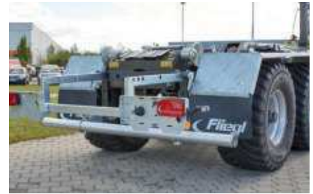
Opcionális: hidraulikus támasztás a tengelynél
