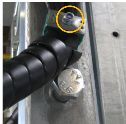
Illustration 30 : desserrage du support
