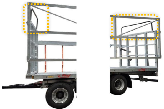
Illustration 45 : mise en place de l'arceau
