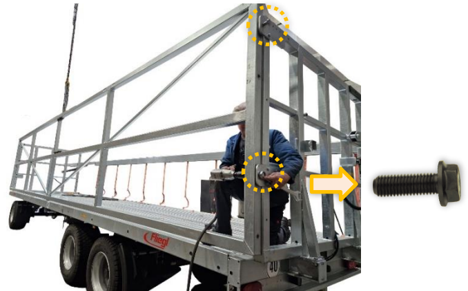
Illustration 39 : retrait des connexions vissées
