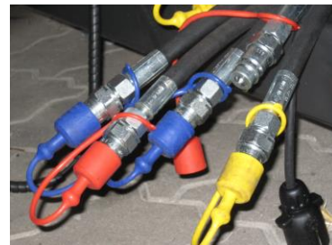
Fig. 12 Montaje de las conexiones
