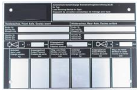
Obr. 94 Nastavitelná délka u regulátoru ALB a štítek ALB na voze
