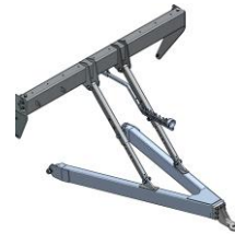
Obr. 62 Odpružení tažné oje
