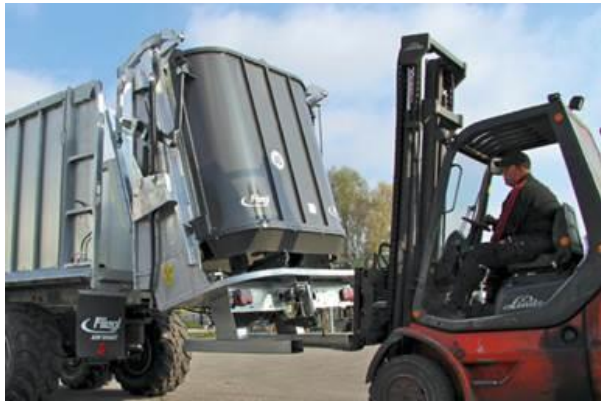
Obr. 55 (De)montáž rozmetaadla pomocí vysokozdvízného vozíku
