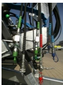
Obr. 20 Barevné označení hydraulických hadic
