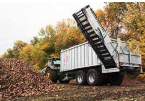
Mit einer Bandbreite von 1000 mm beträgt die Förderleistung ca. 750 t/h
