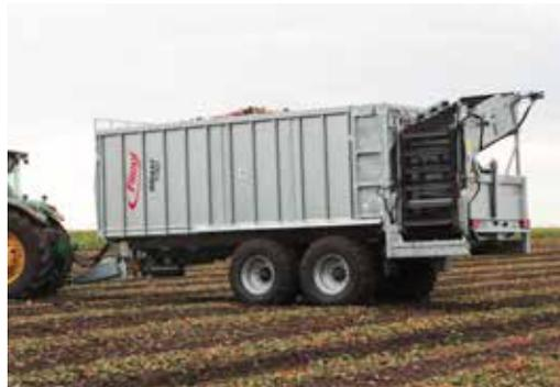
Das hydraulisch klappbare Förderband verringert die Fahrzeughöhe
