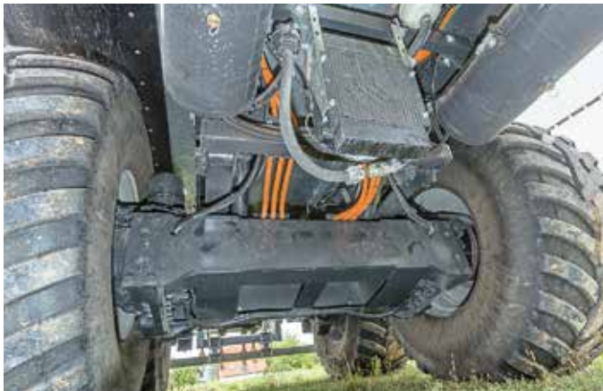
Fliegl modifiziert für den elektrischen Antrieb eine Triebachse von ZF. In den beiden Radmotoren ist eine Kühlung integriert. Die Drehzahl von bis zu 12000 U/min wird mit einem Getriebe reduziert.
