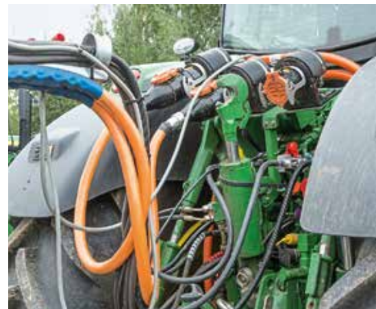
Die Steckverbindungen sind gemäß der AEF-Richtlinie genormt. Der Anbauraum mit drei Steckverbindungen ist eng.
