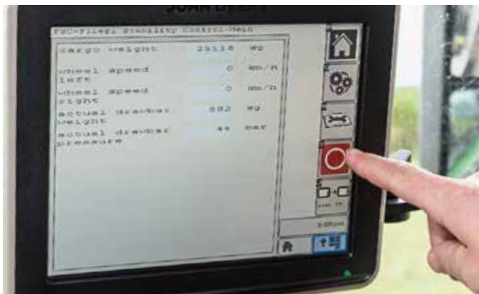
Im ISO-Bus-Terminal muss der Fahrer das System nur einmal aktivieren und natürlich die Frontzapfwelle einschalten. Ansonsten merkt man dank der guten Steuerung während der Fahrt keinen Unterschied.
